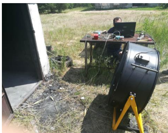
Рисунок 3.11 - Проведення експериментальних досліджень з визначення ефективного зменшення задимленості
