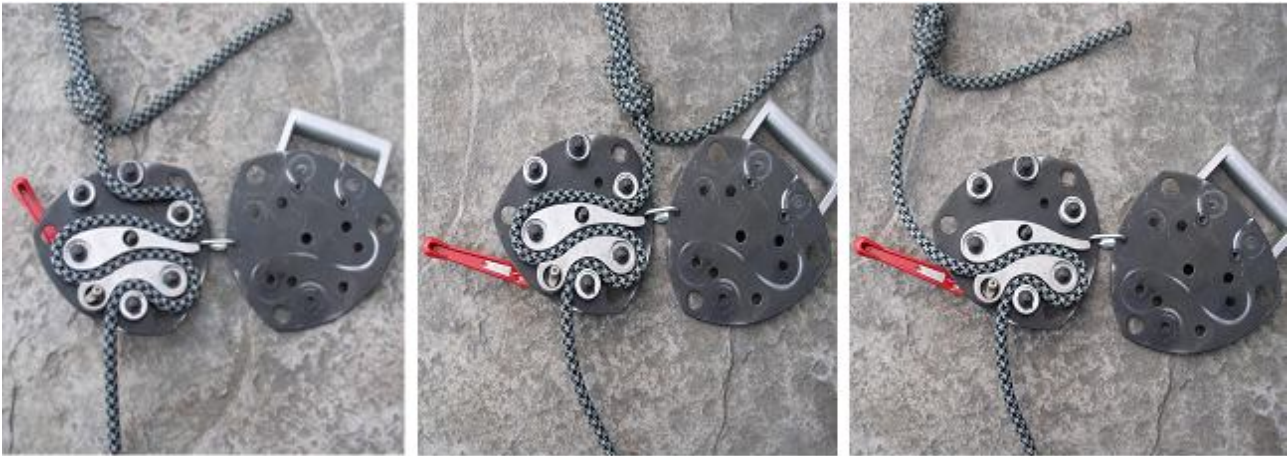
Рис. 2. Схеми заправки мотузки в спусковий пристрій.
