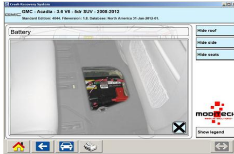
Рис. 1. 12 В батарея автомобіля GMC Acadia розташована в підлозі автомобіля під сидінням пасажирів.
