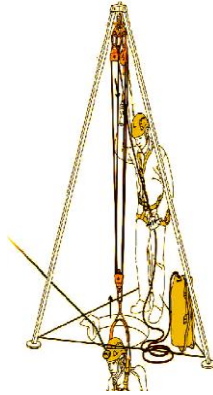
Рис. 1. Спуск рятувальника у каналізаційний колодязь за допомогою рятувальної тринogi, на якій змонтована система поліспаств.
