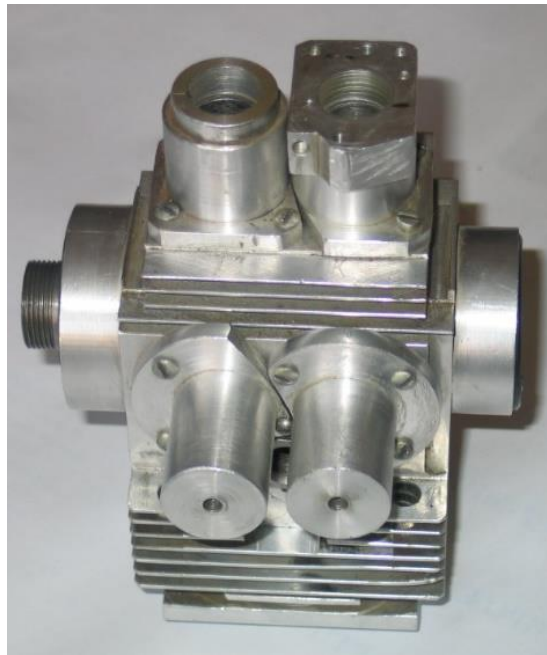
Рис. 1. Експериментальний зразок золотникового механізму газорозподілу.
