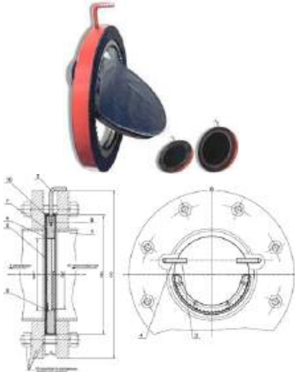
Рисунок 1. Зовнішній вигляд та розріз мембрани «Лотос – 300»
