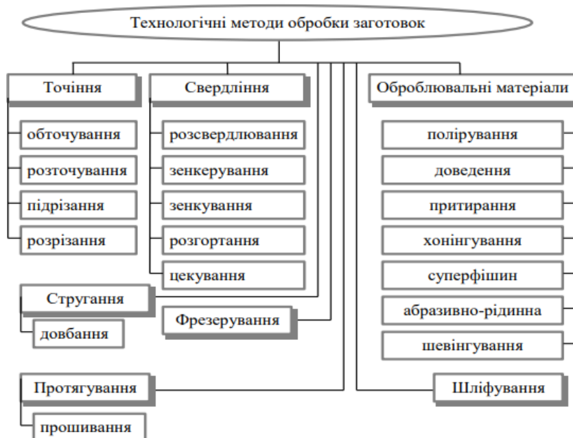
Рис. 1. Види технологічних процесів механічної обробки
