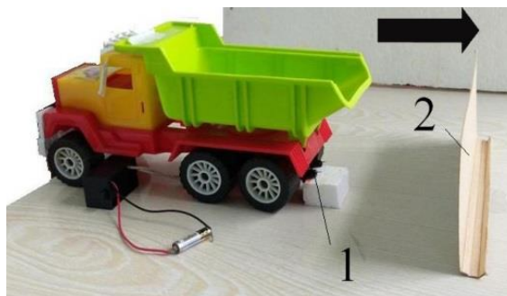
Рисунок 1 – Експериментальна установка: 1 – іонізатор; 2 – захисний екран
