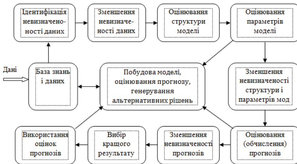
Рис. 2. Послідовність ідентифікації та обробки невизначеностей під час побудови моделей та оцінювання прогнозів
