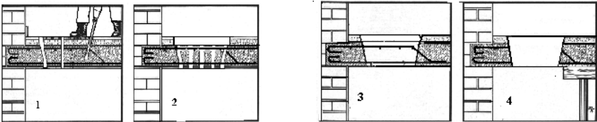
Рисунок 7.8. Порядок виконання пролому в стелі
