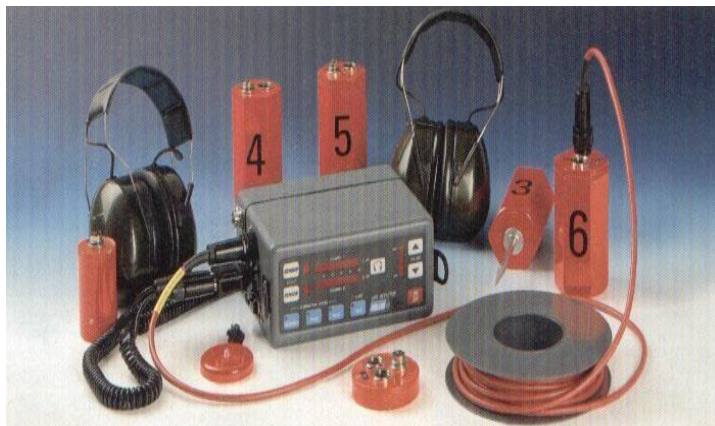
Рисунок 7.5. Загальний вигляд геофона
