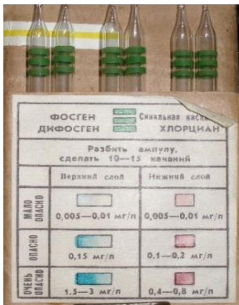
Рисунок 5.2. Індикаторні трубки в касеті
