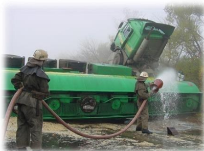
Рисунок 8.14. Попередження займання палива
