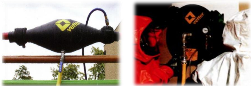
Рисунок 3.6. Локалізація витоків НХР за допомогою спеціальних ущільнювачів
