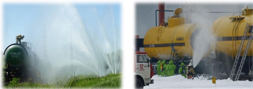
Рисунок 3.7. Створення водяної завіси
