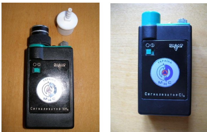
Рисунок 5.6. Газоаналізатор 342 ЄХ 08 (а); Газоаналізатор 662 ЄХ 02 (б)
