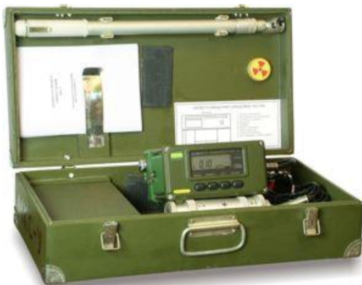
Рисунок 5.12. Дозиметр-радіометр універсальний (модернізований рентгенометр ДП-5В)
