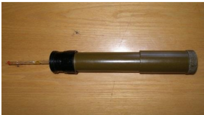
Рисунок 5.3. Насос для прокачування повітря через індикаторні трубки
