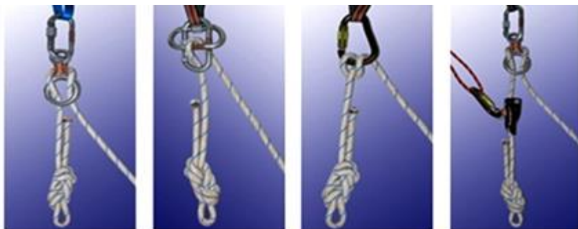
Рисунок 2.20. Організація гальмівної системи з використанням: а – спускового пристрою «вісімка»; б – спеціального вузла «карабінне гальмо»; в – спеціального вузла «UIAA»; г – затискача «Shunt»
