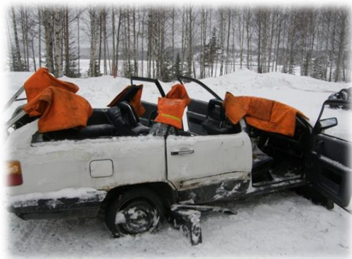
Рисунок 8.16. Вилучення даху автомобіля
