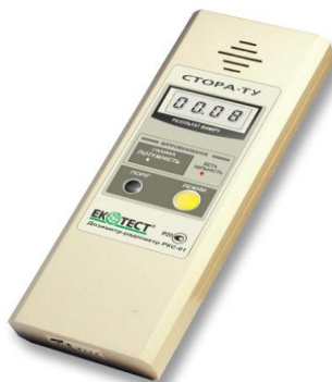
Рисунок 5.8. СТОРА-Т Радіометр-дозиметр гамма-, бета-випромінювань РКС-01
