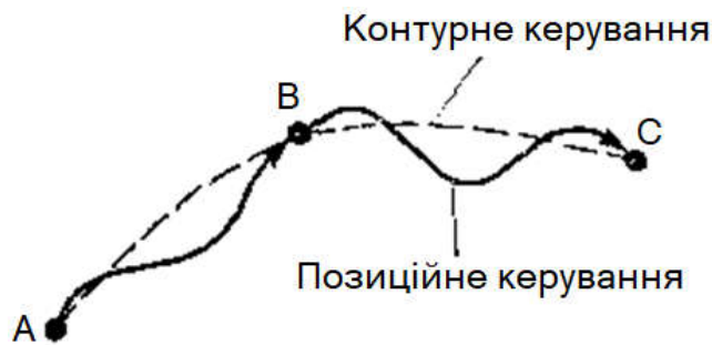
Рис. 2. Відмінності між принципами керування контуром і положенням
