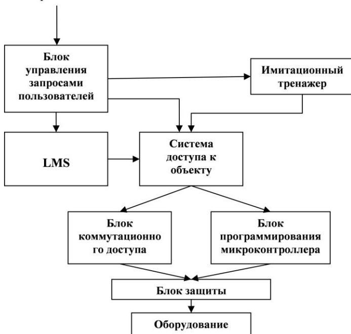
Рисунок 1. Функциональная схема виртуальной лаборатории
