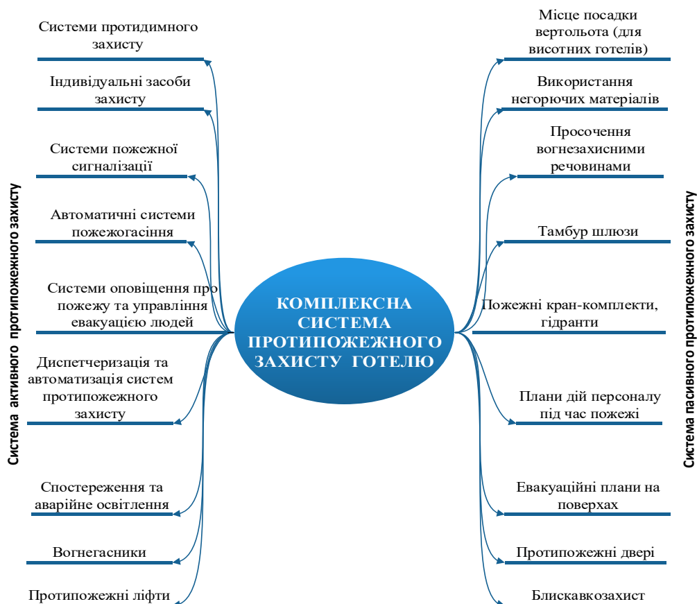
Рис 1. Комплексна система протипожежного захисту готелю
