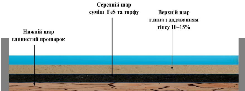
Рисунок 4.3 – Схематичне зображення геохімічного бар'єра від підтериконових стічних вод породних відвалів вугільних шахт
