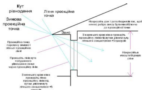
Рис.6. Схема визначення величини звису на виконаному в масштабі перерізі стіни
