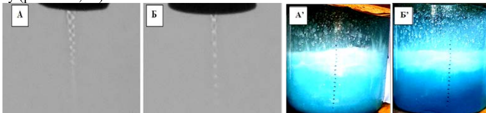
Рис. 1 Фото струменів, що витікають з когерентного типу сопла (А) та порівняльного циліндричного (Б), та фото двофазної моделі продувки через когерентний тип сопла (А') та порівняльний циліндричний (Б')
