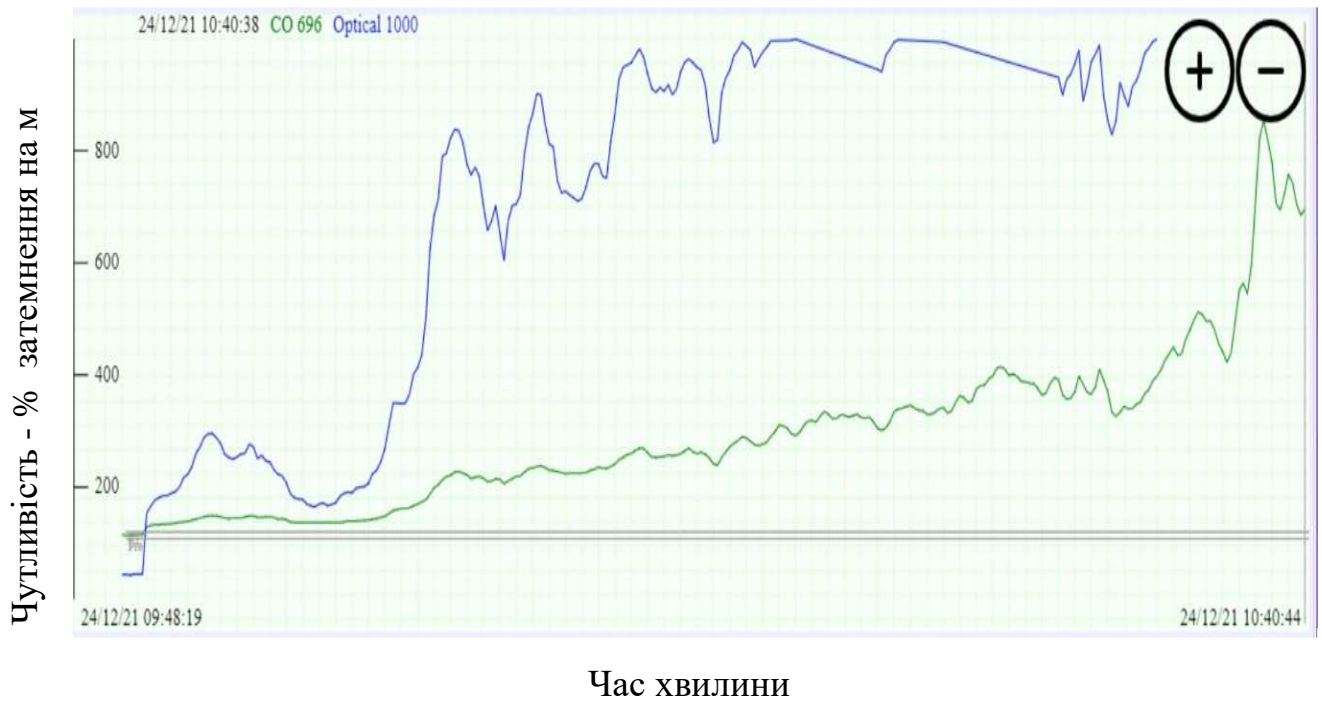
Рисунок – 3.10 Графік зміни складу повітря під час тестової пожежі на предмет виявлення підвищеної концентрації CO (зелена крива), насиченість повітря продуктами горіння (синя крива)
