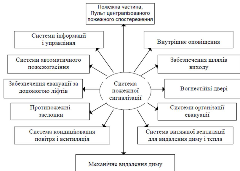
Рисунок – 1.14 Система пожежної сигналізації (СПС) для протипожежного захисту об'єкта [15]
