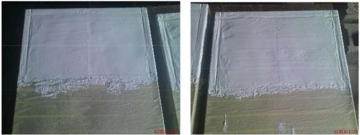
Рисунок 3.6 – Вигляд зразків № 1 та № 2 перед вогневим випробовуванням зі сторони поверхні, що обігрівається
