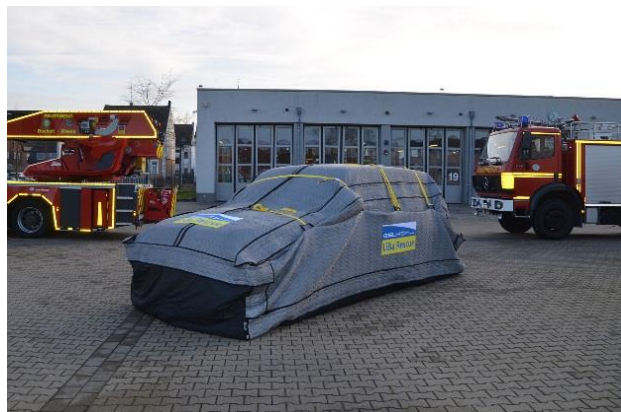
Рисунок 4 – Приклад використання вогнегасної кошми приватної компанії IBENA
