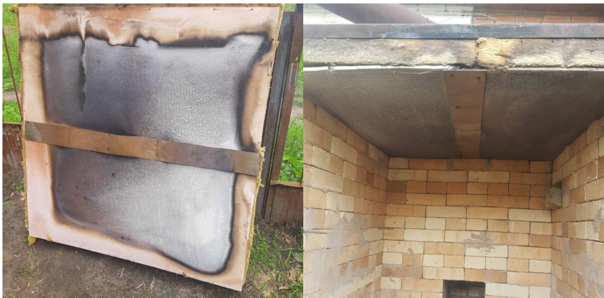
Рисунок 4.20 – Вигляд верхньої кришки після завершення випробувань
