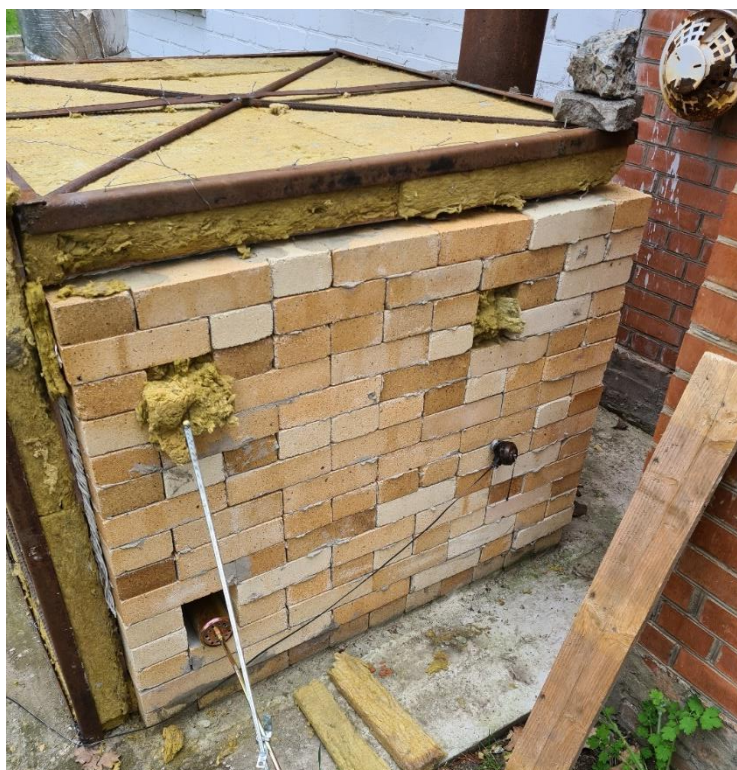
Рисунок 4.19 – Вигляд вогневої печі на 20 хвилині тестового запуску № 2 в процесі випробування
