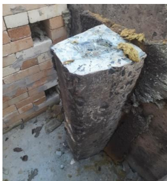
Рисунок 5.32 – Вигляд зразка у вогневій печі після випробування
