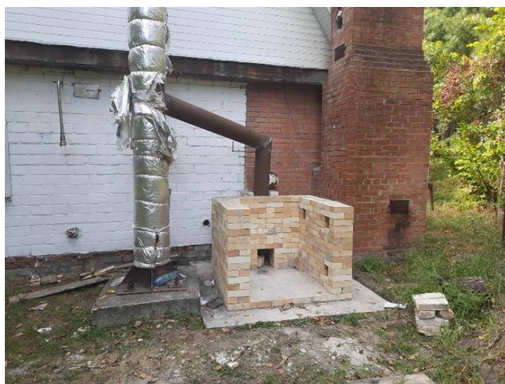
Рисунок 4.8 – Етапи створення камери вогневої печі малогабаритної установки для дослідження теплового впливу пожежі на будівельні конструкції.
