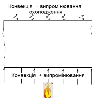
Рисунок 6.18 – Розрахункова схема моделі теплопередачі під час нагрівання ПЛИТ
