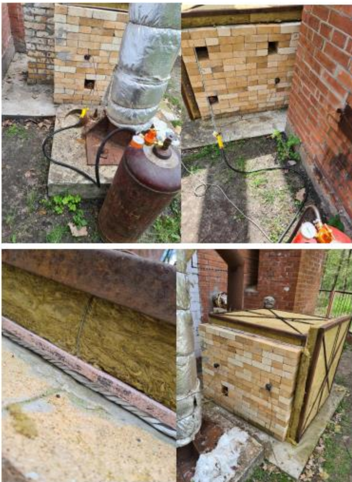
Рисунок 4.18 – Вигляд вогневої печі перед початком тестового запуску № 2
