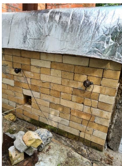
Рисунок 5.17 – Вигляд вогневої печі перед початком випробування
