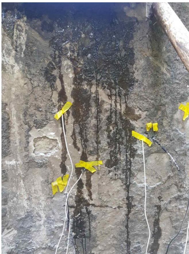
Рисунок 5.9 – Малогабаритний фрагмент залізобетонної стіни після випробування
