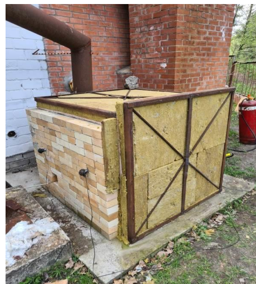
Рисунок 4.8 – Етапи створення камери вогневої печі малогабаритної установки для дослідження теплового впливу пожежі на будівельні конструкції.
