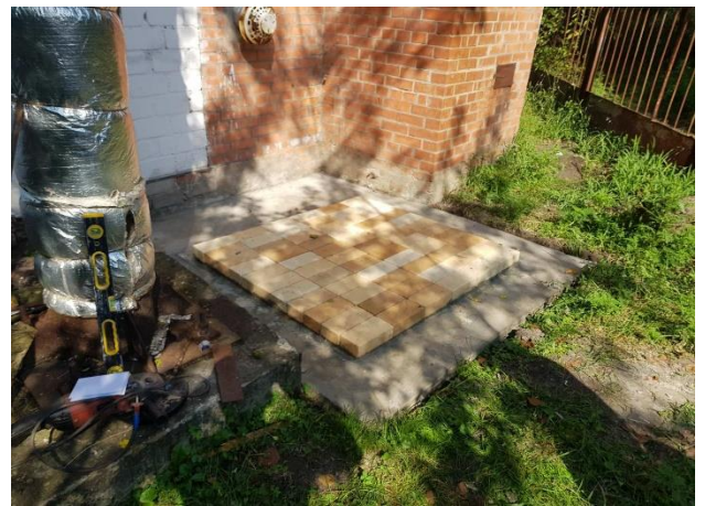
Рисунок 4.7 – Підготовка фундаменту малогабаритної установки для дослідження теплового впливу пожежі на будівельні конструкції
