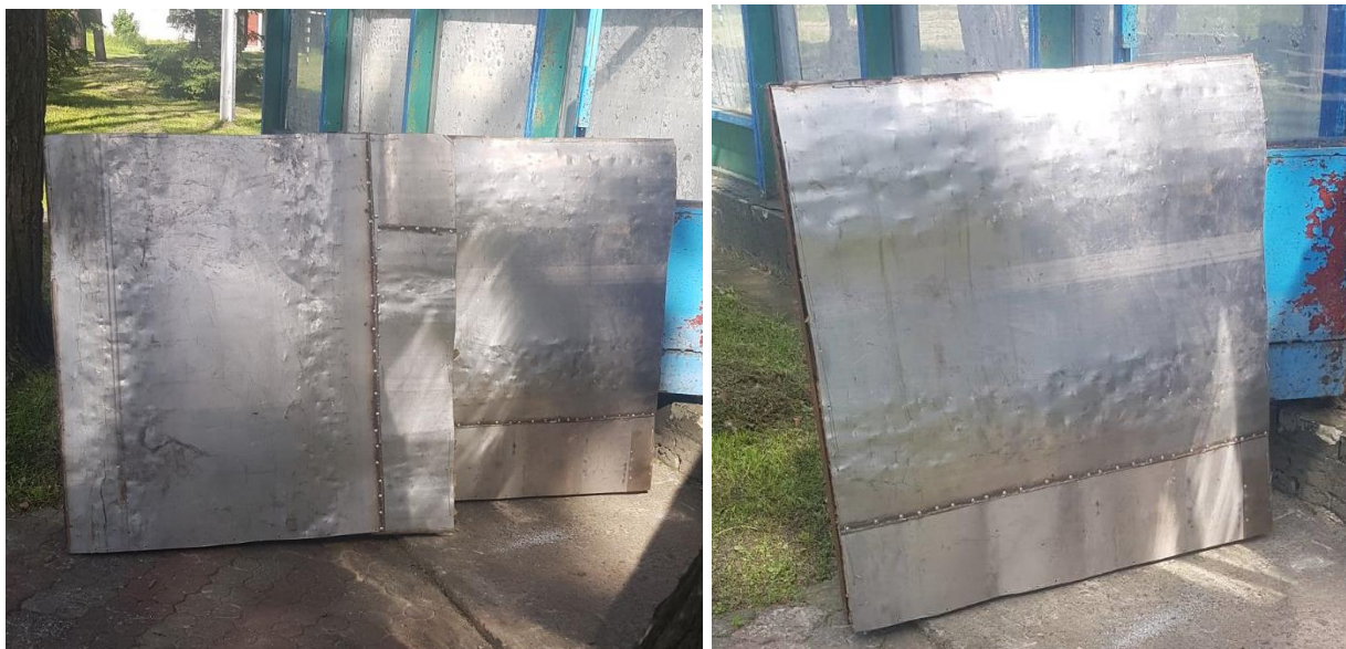
Рисунок 4.22 – Вигляд засобів для ізоляції камери вогневої печі (знімних панелей) для проведення тестового запуску № 3
