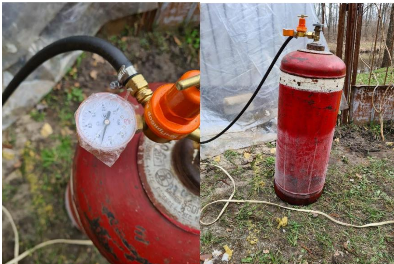
Рисунок 4.15 – Вигляд газового балона системи нагрівання камери печі після 30 хвилини випробувань
