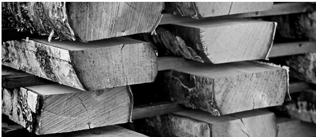
Рисунок 1.7 – Зовнішній вигляд брусків із поперечним перерізом 3×5 см, що підготовлені до випробувань
