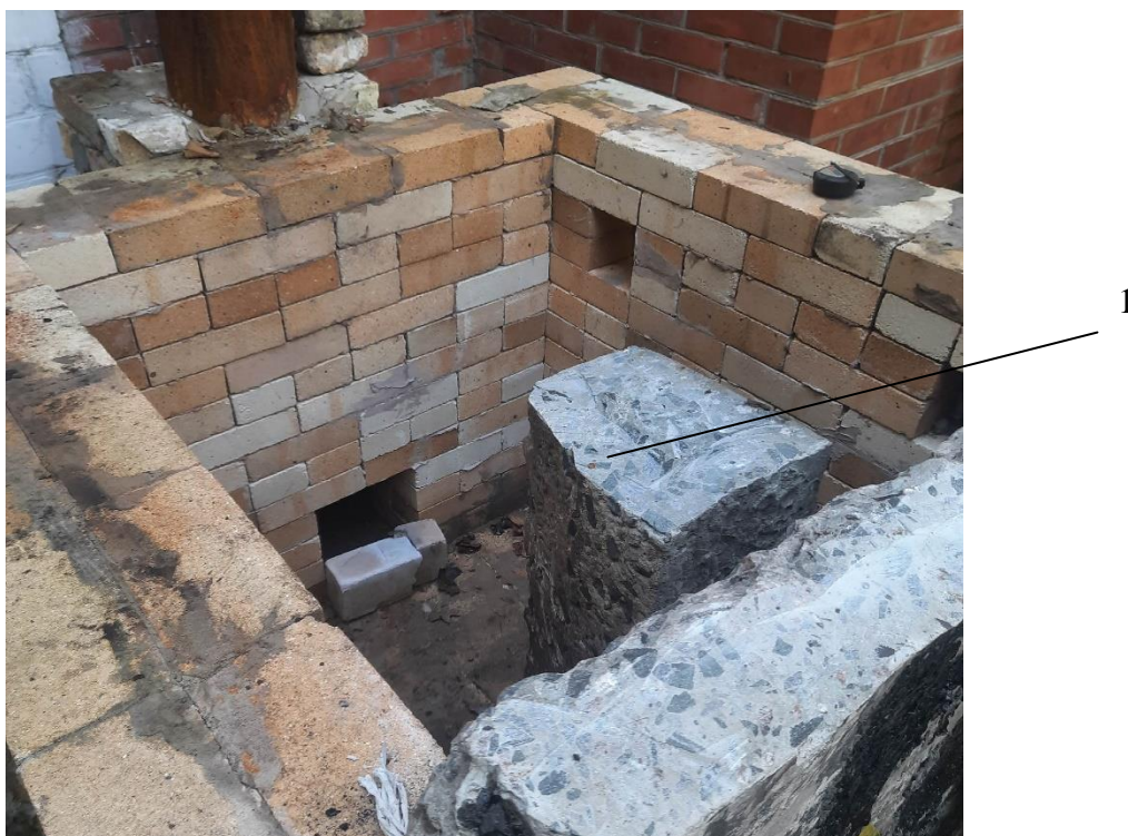
Рисунок 5.29 – Малогабаритний фрагмент залізобетонної балки, виготовленої заздалегідь до випробування: 1 фрагмент заздалегідь виготовленої залізобетонної балки
