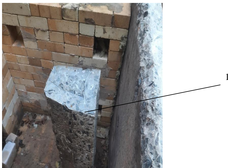
Рисунок 5.23 – Малогабаритний фрагмент залізобетонної колони, виготовленої заздалегідь до випробування: 1 фрагмент заздалегідь виготовленої залізобетонної колони
