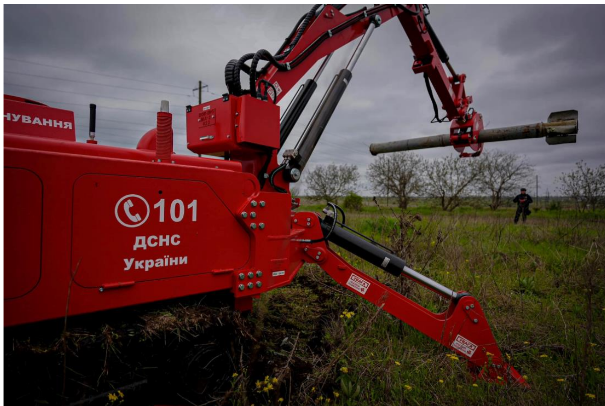
Рис. 1. Механізований комплекс розмінування DOK-ING MV-4
