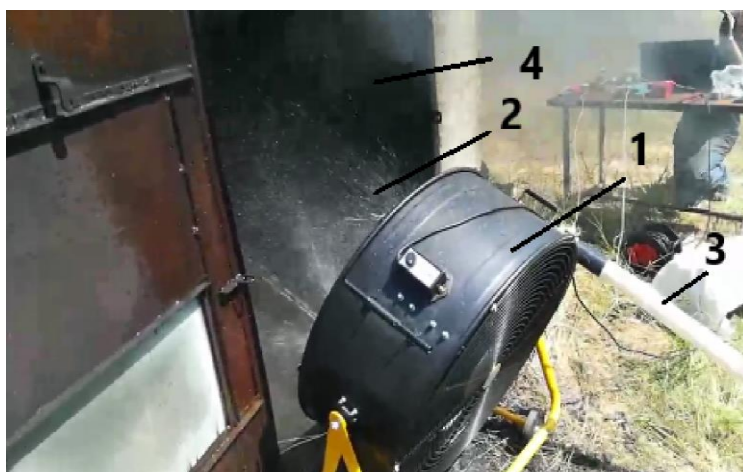
Рисунку 11 – Проведення експериментальних досліджень з визначення ефективного зниження задимленості
