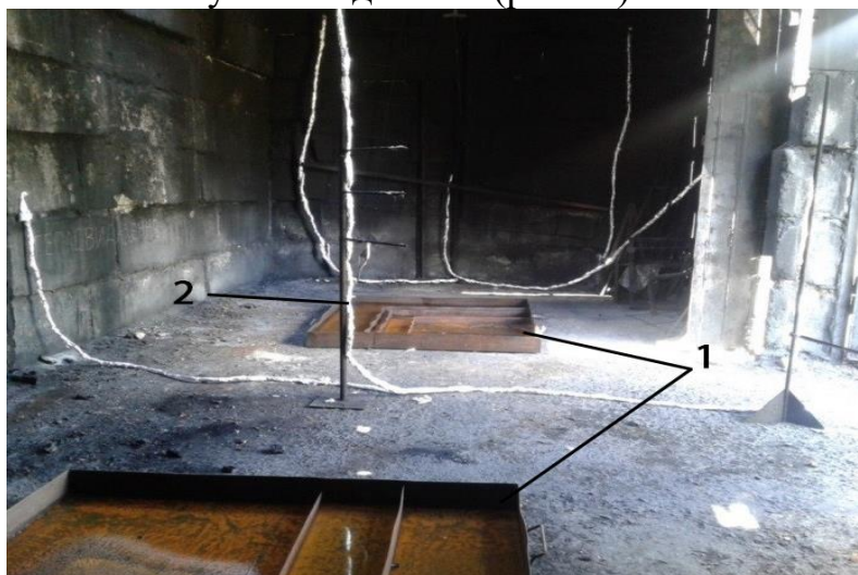
Рисунок 14 – Зовнішній вигляд випробувального боксу з розташуванням модельних вогнищ пожежі класу В
