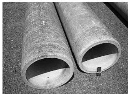
Рис. 2. Азбестоцементні труби (зверніть увагу на товщину стінок у порівнянні з розміром мобільного телефону)
