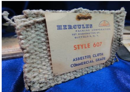
Рис. 1. Ліворуч: компанія Hercules виготовила комерційну азбестову тканину, що містить щонайменше 75% азбесту 2. Праворуч: трубна ізоляція, що містить азбест
