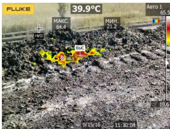
Рисунок 3.35 – Цифрове зображення осередків горіння породного відвалу із відмітками середніх, максимальних та мінімальних температур
