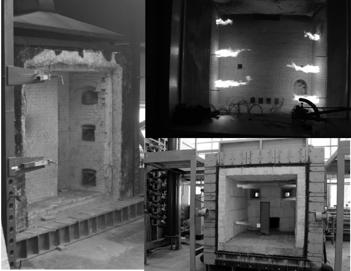
Рис. 1.2. Вертикальні вогневі випробувальні установки для проведення випробувань на вогнестійкість несучих стін.
