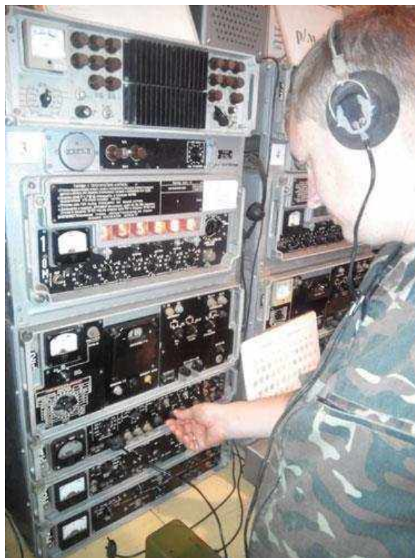
Рис. 3.2 (а). Перевірка працездатності приймача з використанням блока зворотного контролю.
