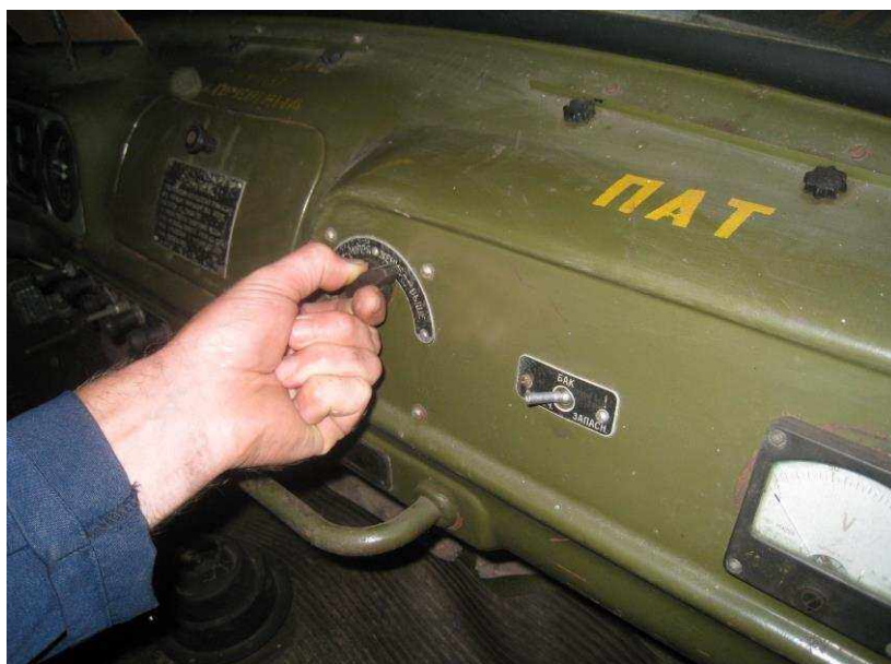
Рис.3.23 (а). Встановлення напруги 110В
