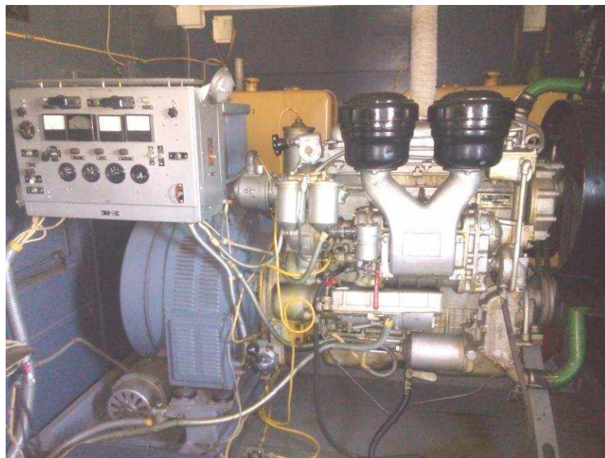
Рис. 3.21 (а). Агрегат живлення АД30-Т230
