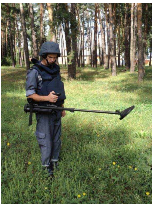
Рис. 4.1.2(а). Налаштування міношукача
