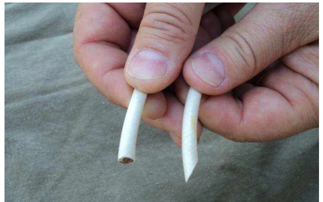
Рис. 4.8.2. Відрізання вогнепровідного шнура ОШП
