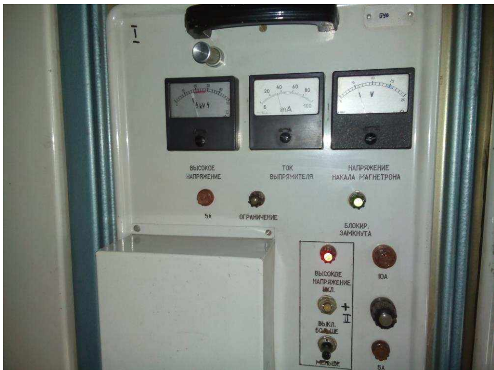
Рис. 3.21 (в) Перевірка вмикання передавачів ПРЛ
