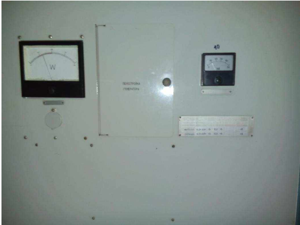
Рис. 3.21 (в). Перевірка потужності передавачів ПРЛ
