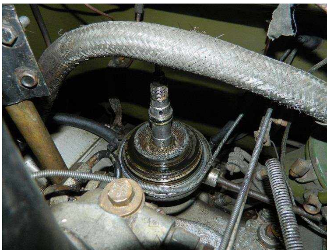
Рис. 14.6. Розбирання, промивка та установка масляного фільтру (центрифуги) двигуна ЗІЛ-131
