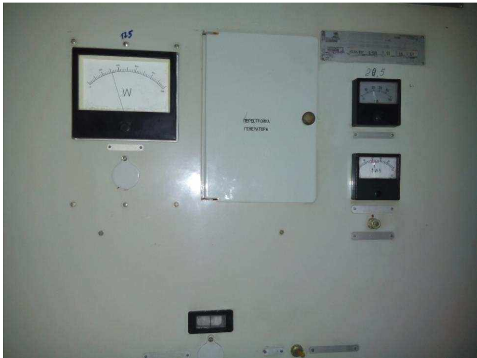
Рис. 3.21 (в). Перевірка потужності передавачів ДРЛ
