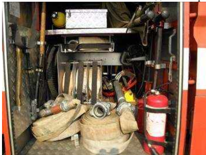
Рис.1.3 (в). Огляд відсіку АЦ-40 на наявність пошкоджень та комплектності спеціального обладнання
