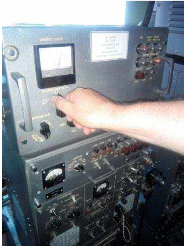
Рис. 3.3 (а). Перевірка напруг живлення радіопередавача Р-140.
