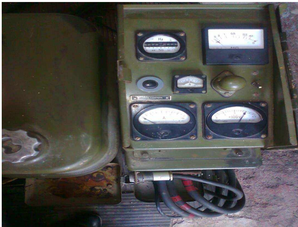
Рис. 3.13 (б). Контроль роботи агрегату живлення Вмикається радіопеленгатор, перемикається на пульті керування в місцевий режим роботи
