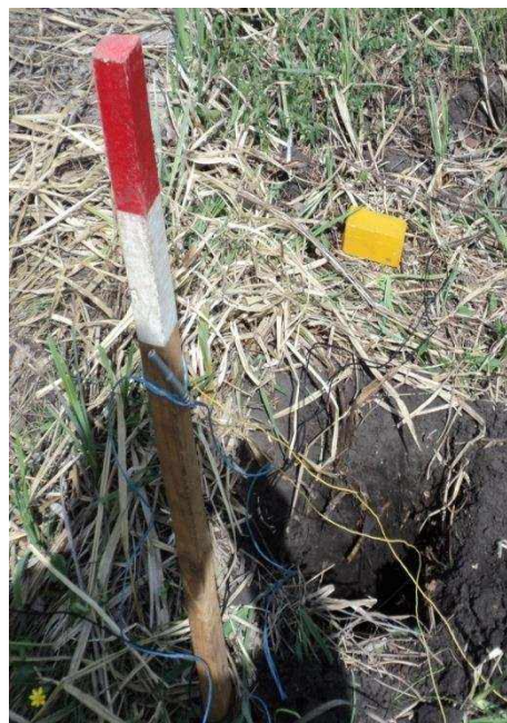
Рис. 4.2.2(б). Укладка зарядів на відстані 0,5 м від ЕДП
