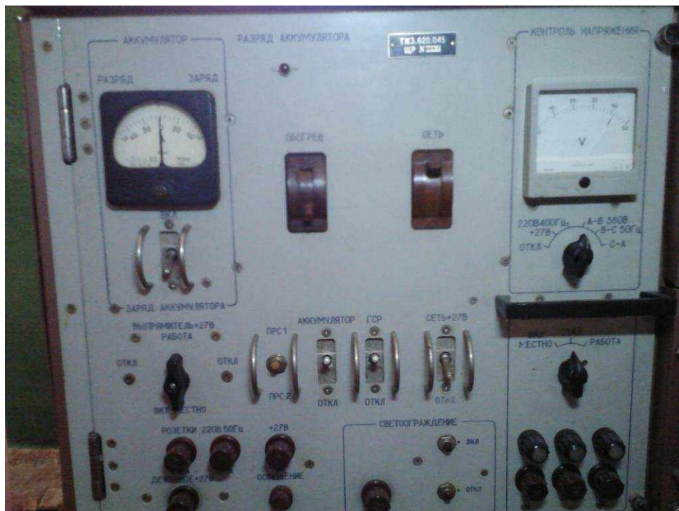
Рис. 3.19 (в). Проверка напруги живлення
