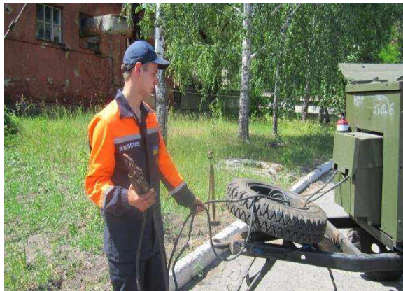
Рис.1.3. Перевірка надійності контактів в зварювальному ланцюзі
