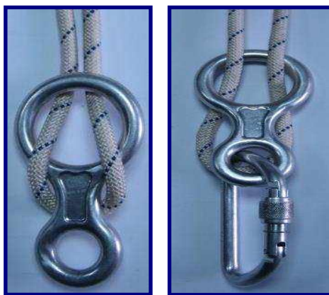
Рисунок 3.7.1. Способи заправлення мотузки в спусковий пристрій «вісімка».
