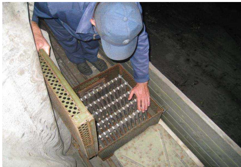
Рис. 3.23 (а). Огляд баластного реостата
