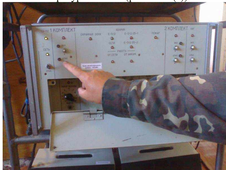
Рис. 3.14 (г). Вимкання 1-го та 2-го комплектів радіопеленгатора
