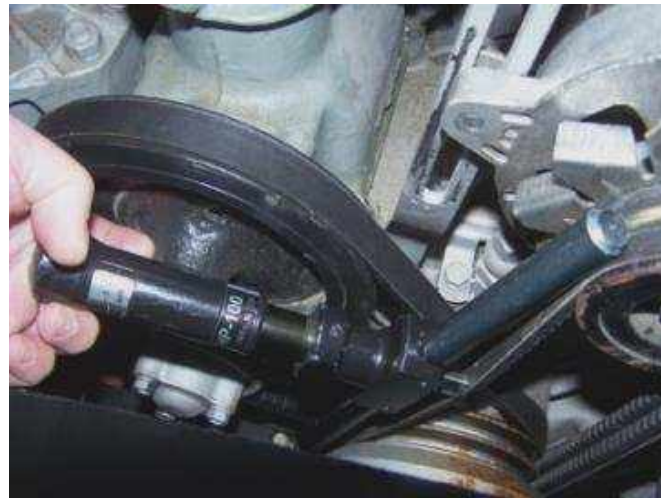
Рис. 21.2. Перевірка натягу за допомогою ППНР-100
