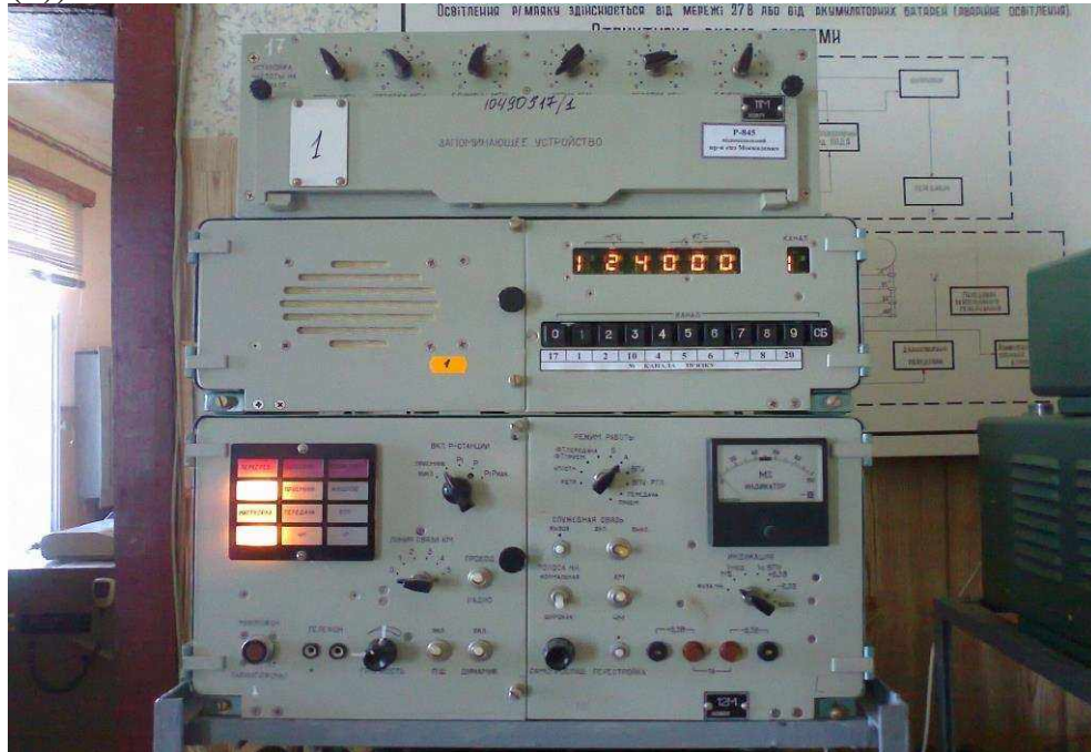
Рис. 3.10 (в). Налаштування напівкомплекту А на задану частоту в метровому діапазоні хвиль на блоці 10М Виконується вихід на зв'язок з кореспондентом (рис. 3.10 (г)).
