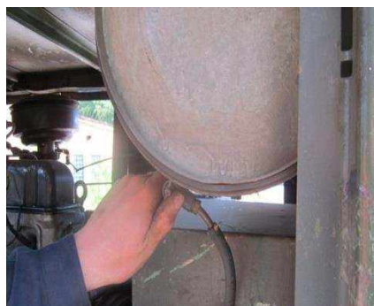
Рис .1.5. Подача палива до карбюратора двигуна
