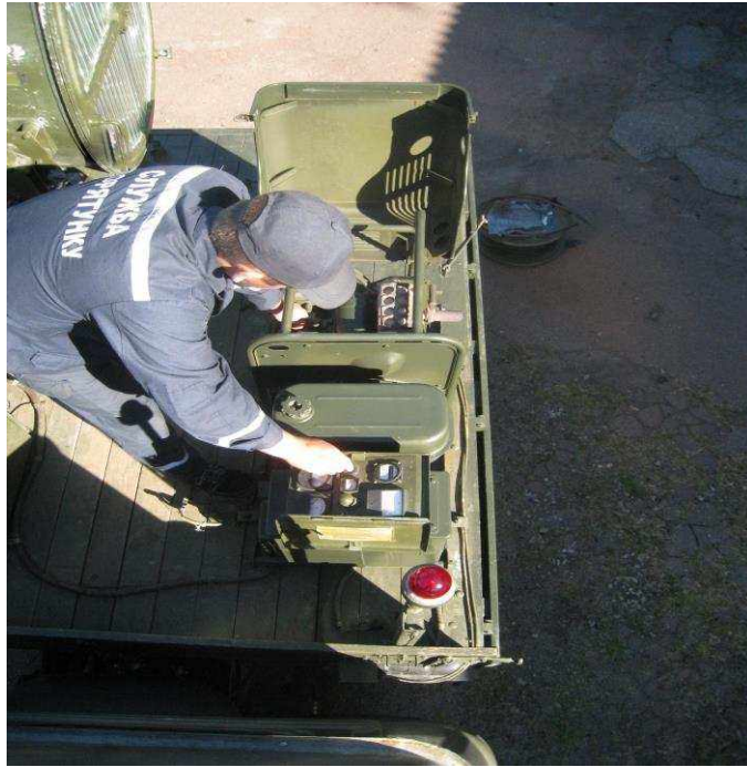
Рис. 3.22 (б). Встановлення напруги 220 В і частоту 50 Гц за допомогою щитового приладу
