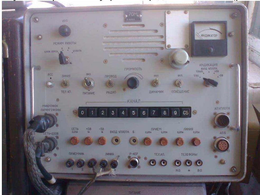
Рис. 3.10 (д). Зовнішній вид ВПУ блок 70М
