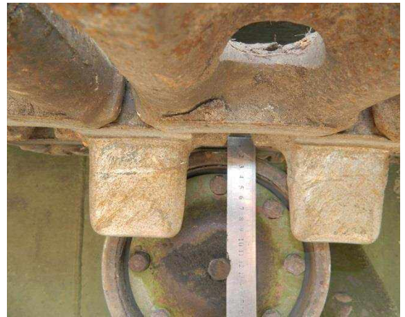
Рис. 4.3. Регулювання натягу гусеничних стрічок
