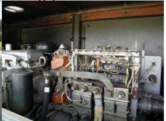
Рис.1.7 (б). Перевірити кріплення рухомих приладів та вузлів
