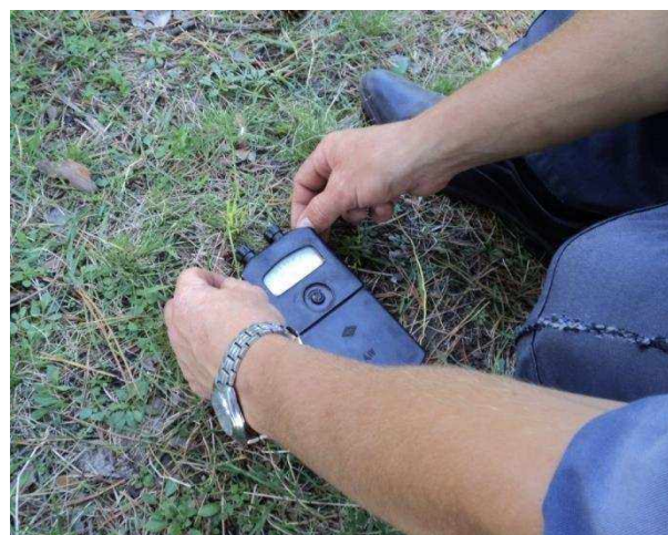
Рис. 4.3.3. Перевірка електропровідності електродетонатора
