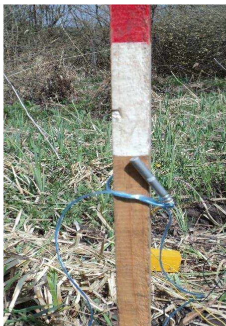
Рис. 4.2.2(а). Прив'язування ЕДП до віхи
