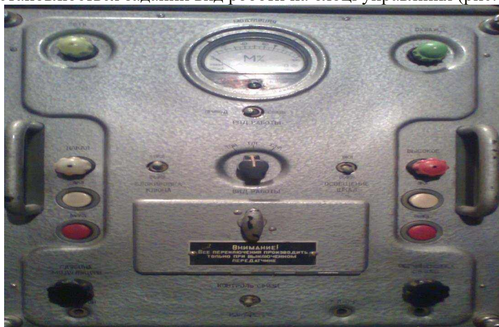
Рис. 3.16 (г). Встановлення заданого виду роботи на блоці управління
