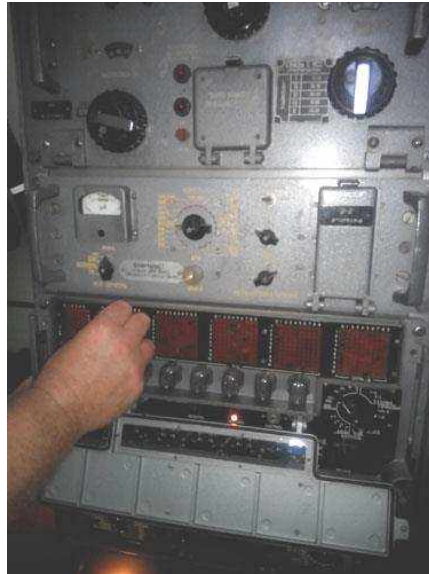
Рис. 3.4 (а). Встановлені органи налаштування передавача згідно з частотою та табличними даними
