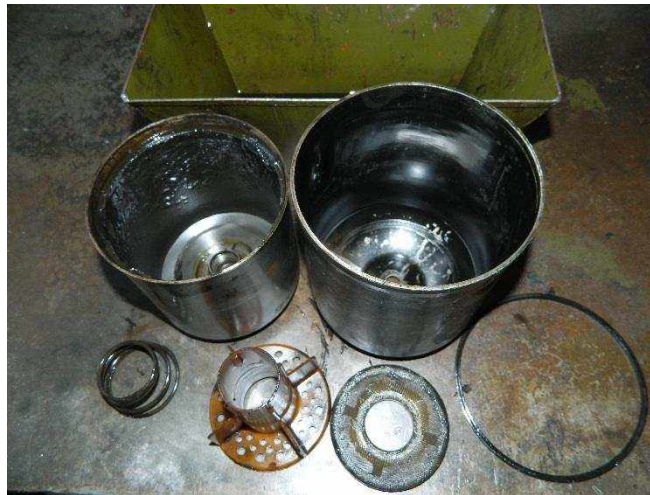
Рис. 14.7. Розбирання, промивка та установка масляного фільтру (центрифуги) двигуна ЗІЛ-131
