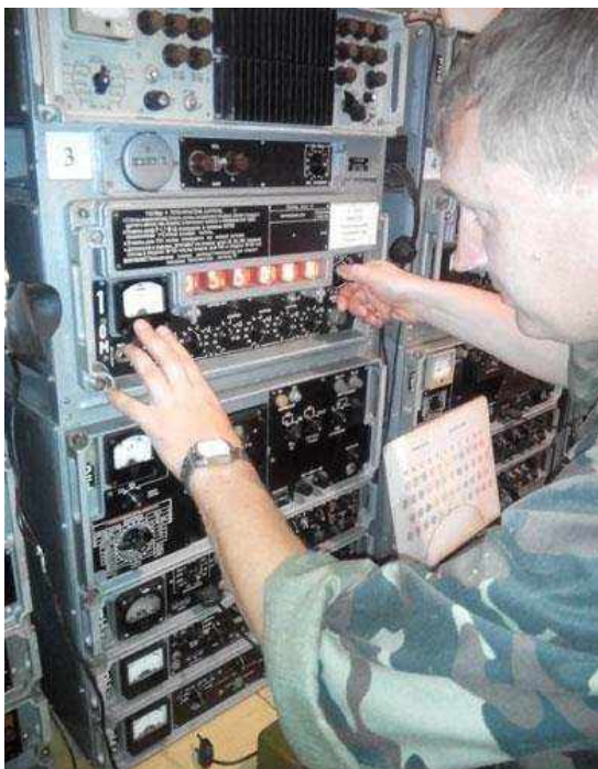
Рис. 3.1 (б). Перевірка струмів ламп і напруги живлення за вмонтованими приладами радіоприймача Р-155П
