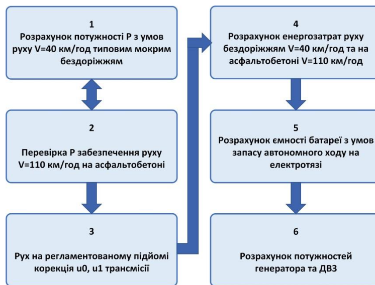
Рис. 2. Структура алгоритму розрахунку необхідних характеристик базових агрегатів гібридного приводу послідовної схеми автомобіля для бездоріжжя
