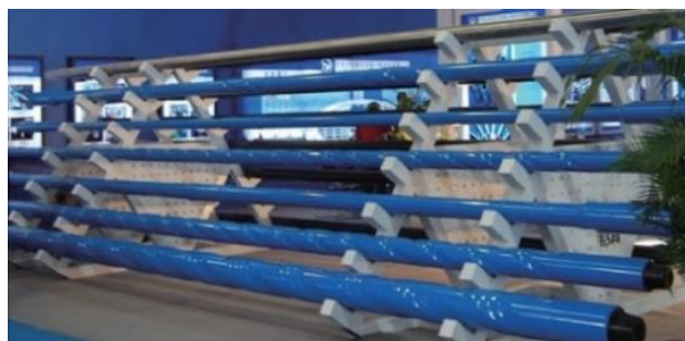
Рис.1 – Типові бурові штанги для буріння нафтових свердловин
