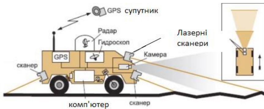
Рис.2 – Автономне управління за допомогою лазерних сканерів
