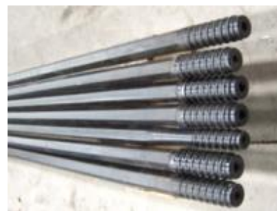
Рис.1 – Типові бурові штанги для буріння нафтових свердловин
