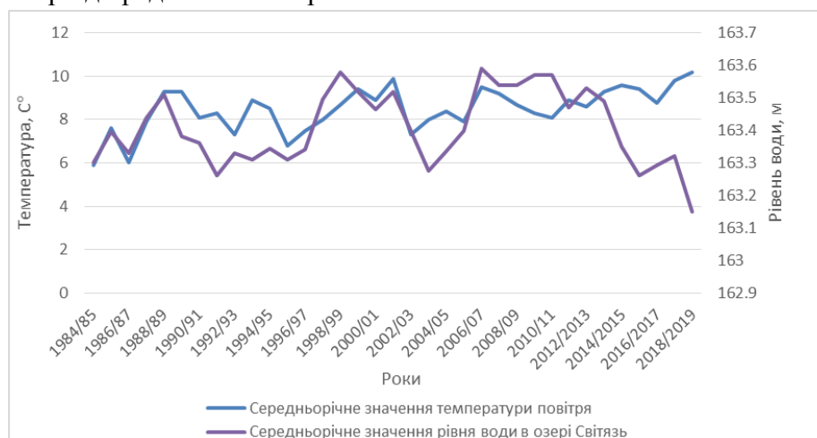
Рис.1. Залежність між середньорічною температурою повітря та рівнем води в оз. Світязь
