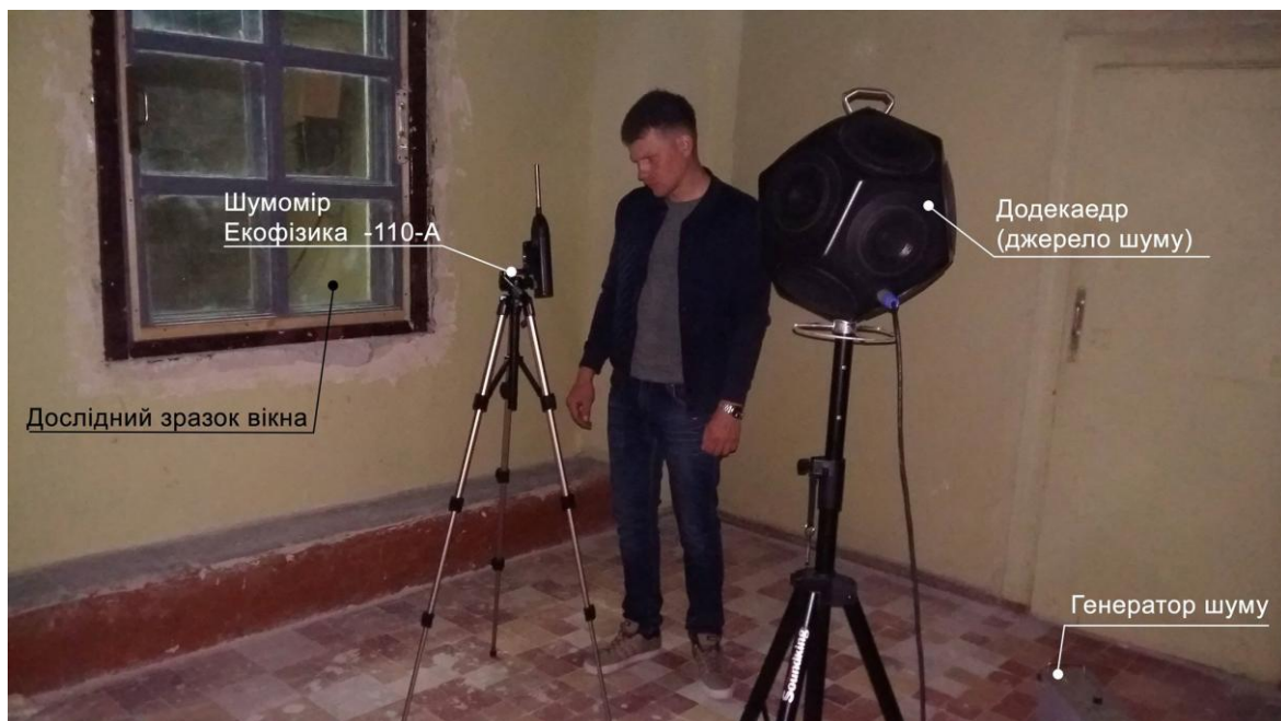
Рис. 1. Виміри шуму в ревербераційній камері (камера високого рівня)
