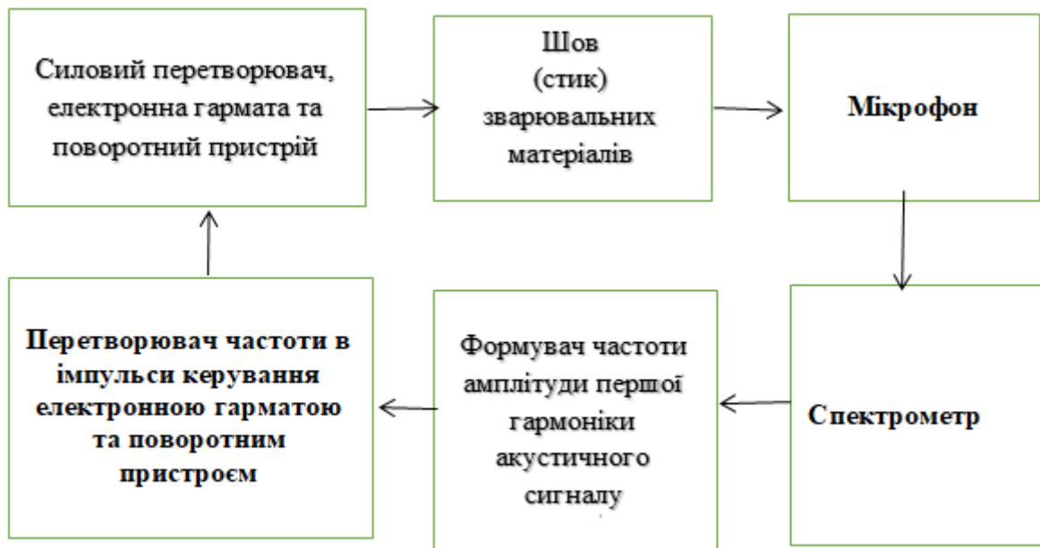
Рис. 1. Структурна електрична схема пристрою для автоматичного наведення на стик електронного променя
