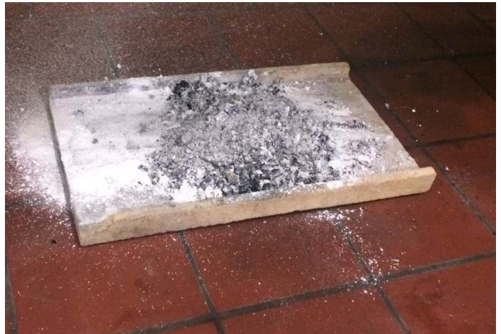
Рисунок 2 – Результати випробувань вогнегасних порошоків для гасіння магнію
