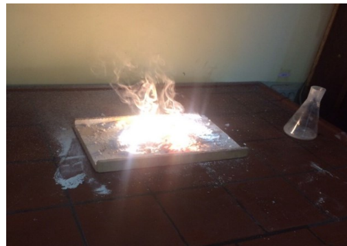
Рисунок 1 – Лабораторні вогневі випробування вогнегасних порошків для гасіння легких металів
