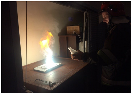
Рисунок 1 – Лабораторні вогневі випробування вогнегасних порошків для гасіння легких металів
