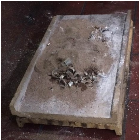
Рисунок 2 – Результати випробувань вогнегасних порошоків для гасіння магнію
