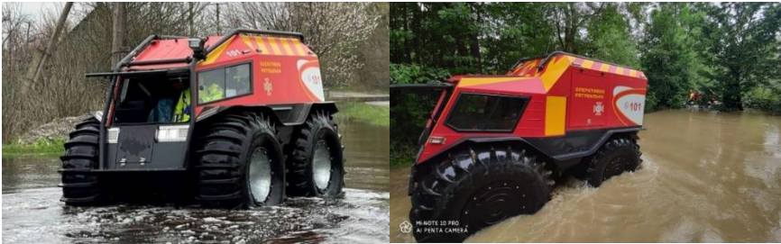
Рисунок 1 – Зовнішній вигляд всюдихода Богун (Sherp)
