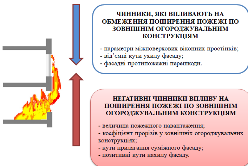
Рисунок 22 – Принципова схема взаємозв'язків чинників, які впливають на процеси поширення фасадних пожеж
