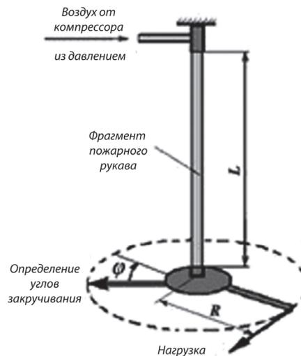
Рис. 1. Опытная установка с установленным фрагментом пожарного рукава
