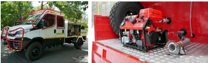
Рисунок 1 – Автомобіль для гасіння лісових пожеж АЛП-7(55S18)538I: а) загальний вигляд автомобіля; б) насосне устаткування автомобіля Johstadt ZL500H
