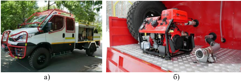
Рисунок 1 – Автомобіль для гасіння лісових пожеж АЛП-7(55S18)538І: а) загальний вигляд автомобіля; б) насосне устаткування автомобіля Johstadt ZL500H
