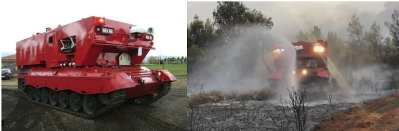
Рисунок 4 – Пожежна машина на шасі танка Leopard 1A5: а) загальний вигляд; б) фото гасіння низової лісової пожежі
