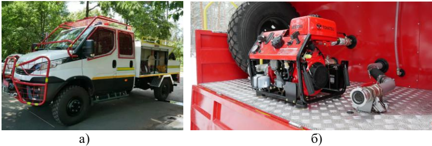
Рисунок 1 – Автомобіль для гасіння лісових пожеж АЛП-7(55S18)538I: а) загальний вигляд автомобіля; б) насосне устаткування автомобіля Johstadt ZL500H
