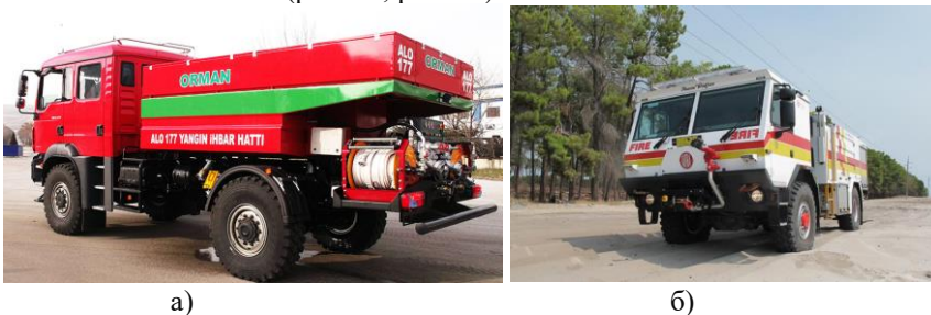
Рисунок 2 – Автомобілі для гасіння лісових пожеж: а) KRB-FFSI в пожежній охороні Туреччини; б) CAS30-TATRA815-7 в пожежній охороні Австралії
