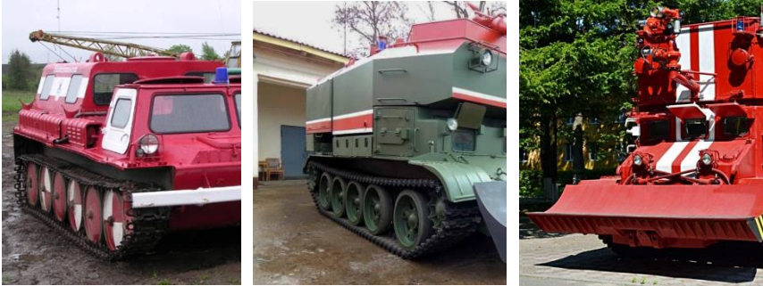
Рисунок 3 – Протипожежна техніка на гусеничному шасі, яка використовується для гасіння лісових пожеж: а) ВПЛ-149; б) ГПМ-54; в) ГПМ-72
