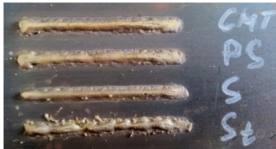
Рис. 2. Наплавлені валики методом MIG-паяння в режимах:
