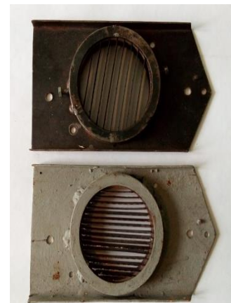
Рис 3. Лабораторна установка для визначення зусилля розрізання (яблука) на пластинки:
