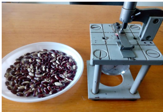
Рис. 2. Процес визначення зусилля руйнування квасолі Fig. 2. The process of determining the breaking force of beans
