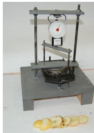
Рис 3. Лабораторна установка для визначення зусилля розрізання (яблука) на пластинки:
