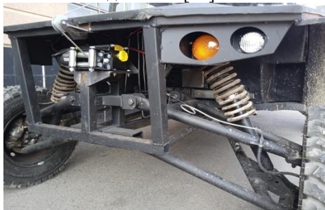
Рис.2. Передня довгоходова підвіска на поперечних А-подібних важелях (легкий ударний автомобіль – багі ТУР КВ 02 „Мамай”)
