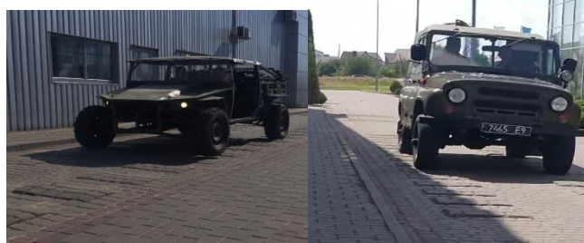
Рис.4. Автомобілі підвищеної прохідності ТУР KB 022 «Мамай» та УАЗ 3151 підчас випробувань - оцінки плавності руху на спеціальній тестовій ділянці.
