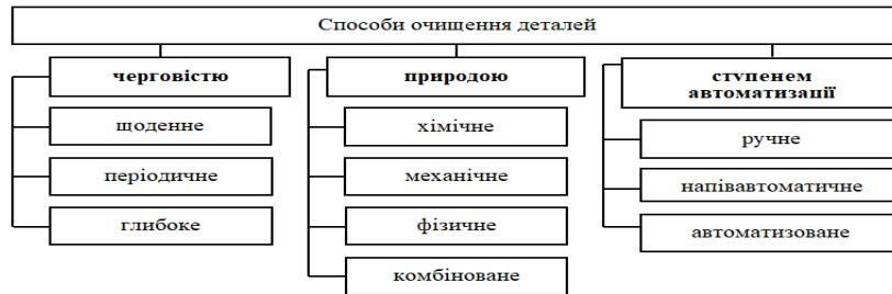
Рис. 2. Класифікація способів очищення деталей та пристроїв
