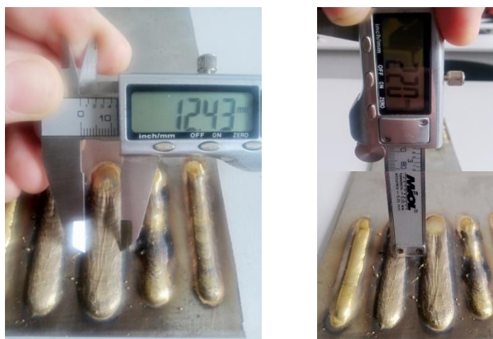
Рис. 3. Вимірювання розмірів зварного шва Fig. 3. Measuring of weld dimensions
