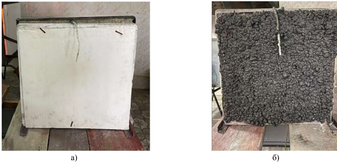
Рис. 7. Вигляд дослідного зразка сталеві пластини товщиною 0,3 см із товщиною вогнезахисного покриття 0,3 мм: а) – до випробувань; б) – після випробувань
