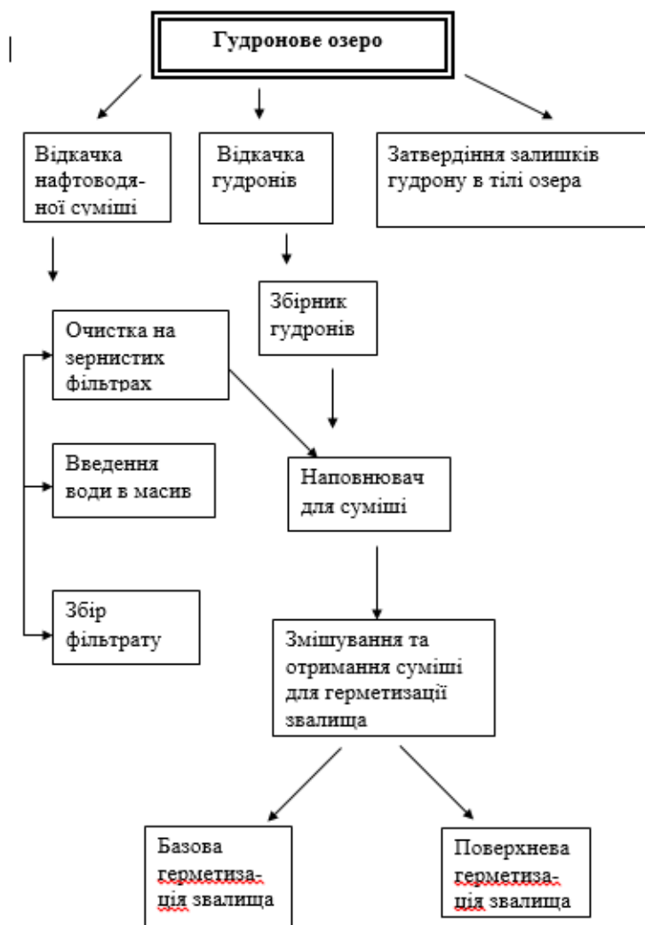
Рис. 4.8. Принципова схема рекультивації гудронових водойм
