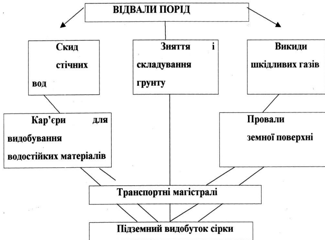
Рис. 1.2 Порухення природних ландшафтів при відкритому та підземному видобутку сірчаної руди [5]
