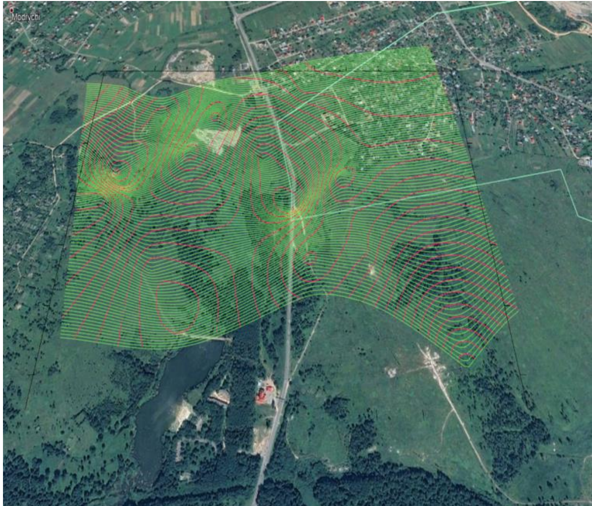
Рис. 3.8 3D – модель вертикальних деформацій території рудника №2 Стебницького ГХП “Полімінерал” за даними ГНСС вимірів [30]
