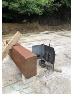
Рисунок 5.20 – Фото проведення експерименту при дослідженні динаміки зміни температури силових літій-іонних елементів батарей електромобілів заряджених на 100%
