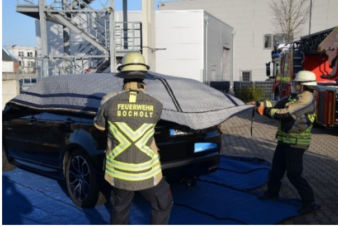
Рисунок 7.12 – Використання вогнегасної ковдри для гасіння електромобілів [375, 376]
