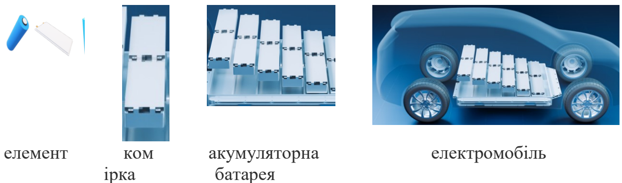
Рисунок 1.19 – Загальна будова силової АКБ електромобіля
