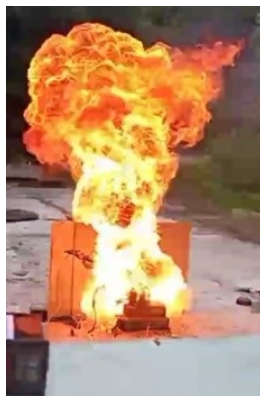
Рисунок 5.21 – Фото горіння вентиляційних газів при дослідженні динаміки зміни температури силових літій-іонних елементів батарей електромобілів заряджених на 100% вертикально розміщеної анодом до модельного вогнища пожежі
