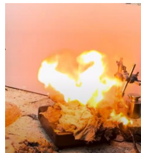
Рисунок 5.25 – Фото проведення експериментальних досліджень а) кріплення силових літій-іонних акумуляторів на електронагрівальній панелі б) горіння силових літій-іонних акумуляторів
