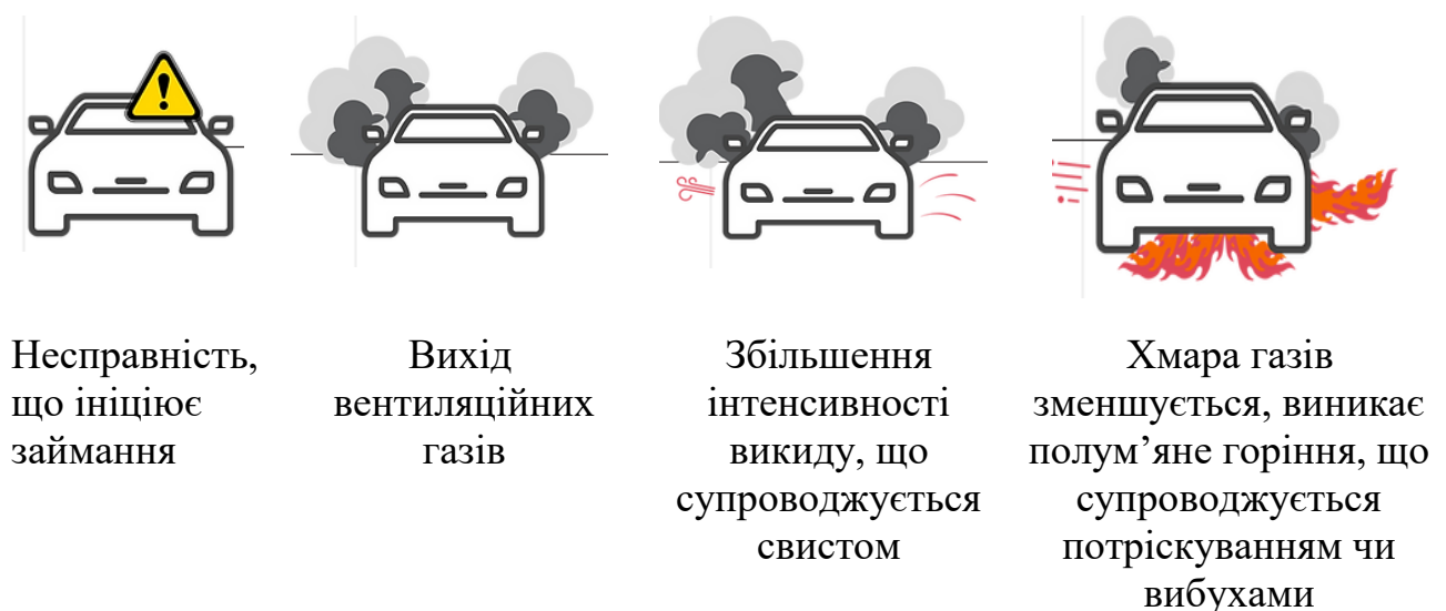
Рисунок 1.27 – Основні етапи розвитку пожежі електромобіля.
