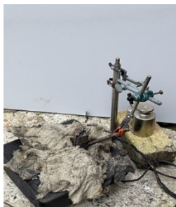
Рисунок 5.25 – Фото проведення експериментальних досліджень а) кріплення силових літій-іонних акумуляторів на електронагрівальній панелі б) горіння силових літій-іонних акумуляторів
