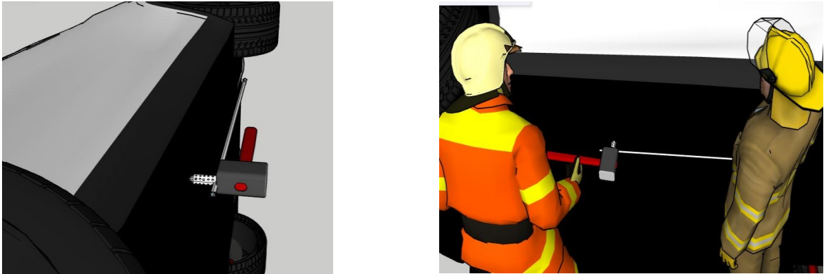
Рисунок 7.19 – Загальний вигляд застосування ствола-пробійника для гасіння силових АКБ електромобілів
