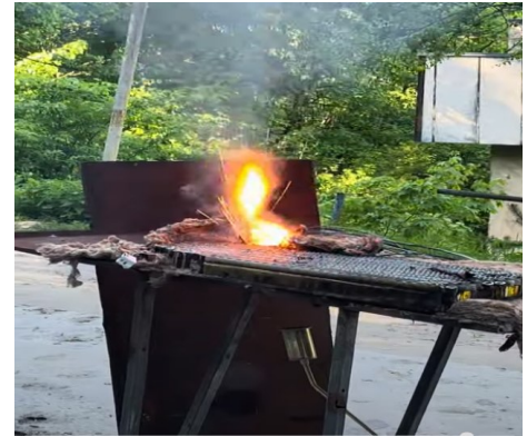
Рисунок 5.67– Зовнішній вигляд розміщення модуля перед початком проведення експерименту та його горіння перед початком гасіння
