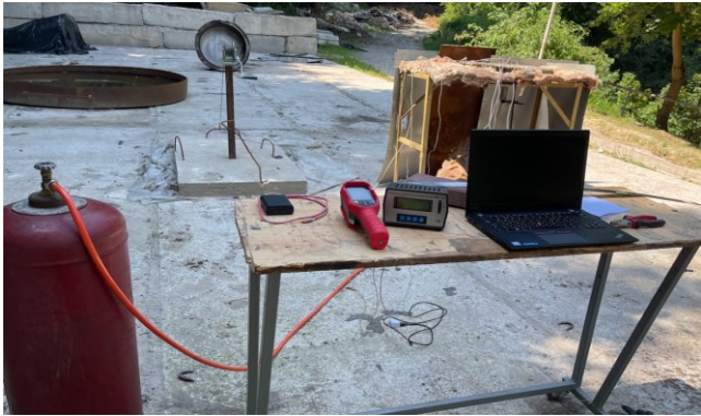
Рисунок 5.67– Зовнішній вигляд розміщення модуля перед початком проведення експерименту та його горіння перед початком гасіння
