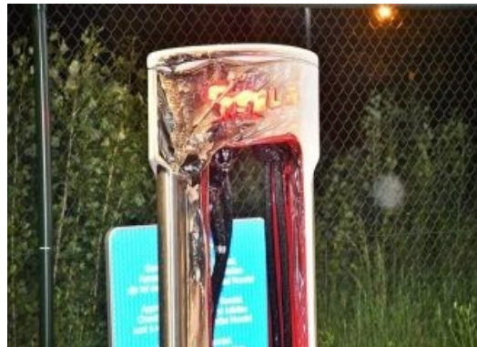
Рисунок 1.14 – Термічний вплив від пожежі Tesla Model S на зарядну станцію.
