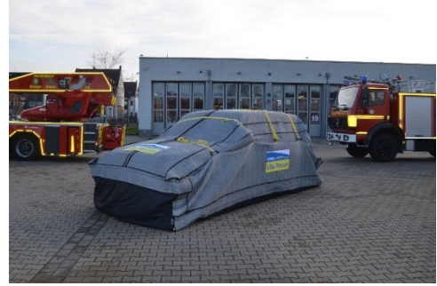
Рисунок 7.12 – Використання вогнегасної ковдри для гасіння електромобілів [375, 376]
