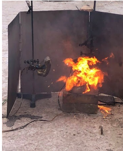
Рисунок 5.6 – Фото викиду газів через вентиляційний отвір і їх горіння під час досліджень динаміки зміни температури розряджених силових літій-іонних елементів батарей електромобілів просторово розміщених анодом до модельного вогнища класу В.
