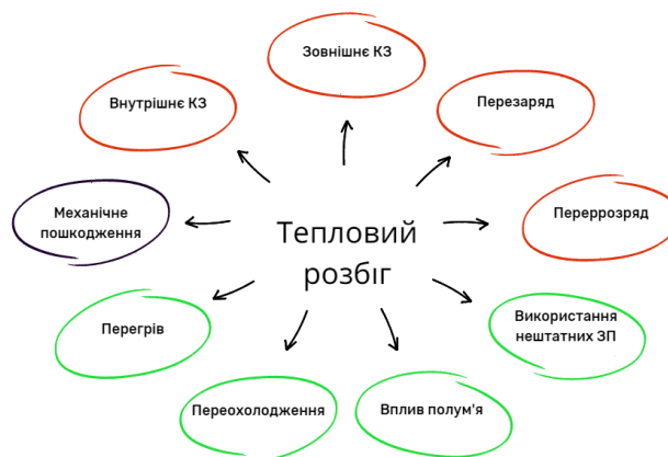
Рисунок 1.25 – Основні причини виникнення термодеструктивного процесу
