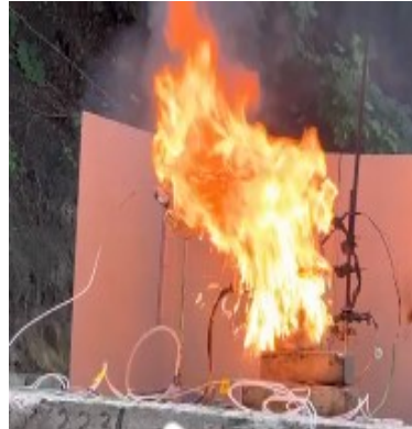
Рисунок 5.13 – Фото горіння вентиляційних газів та розбризування пального при дослідженні динаміки зміни температури силових літій-іонних елементів батарей електромобілів заряджених на 50% просторово розміщених анодом до модельного вогнища класу В.
