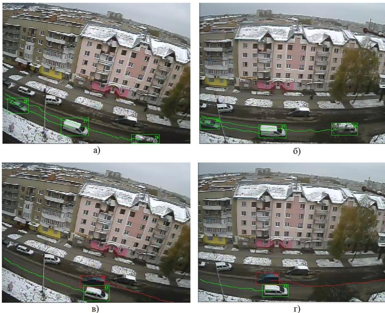
Рисунок 3 - Результат супроводу рухомих об'єктів у зоні перетину полів зору камер відеоспостереження
