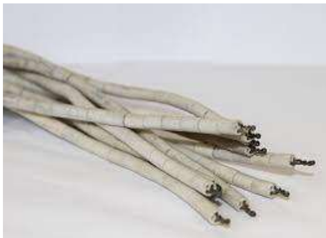
Рисунок 4.2 – Конструктивна схема термопар для вимірювання та контролю температур
