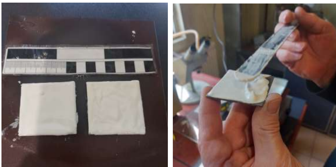
Рисунок 3.5 – Сталеві пластини із нанесеним вогнезахисним покриттям
