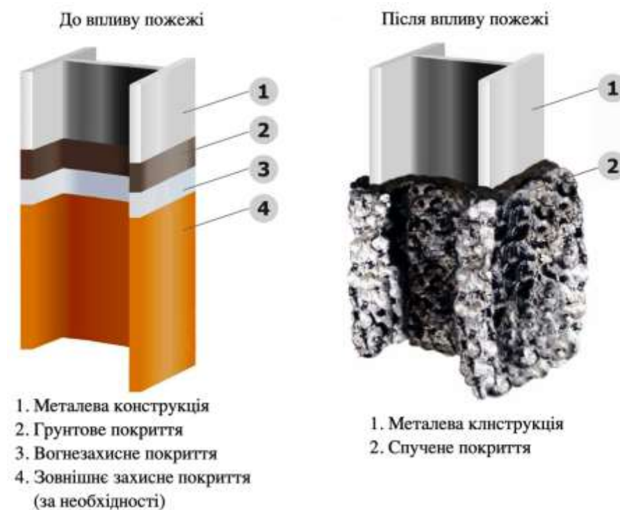
Рисунок 1.1 – Вигляд будівельної сталеві конструкції з нанесеним вогнезахисним інтумесцентним покриттям до та після пожежі
