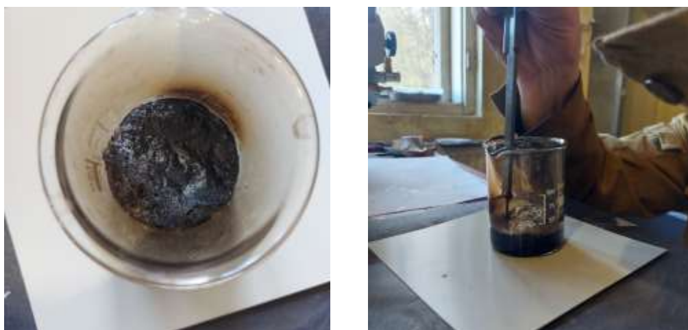
Рисунок 3.4 – Зразки спученого покриття після проведення випробувань
