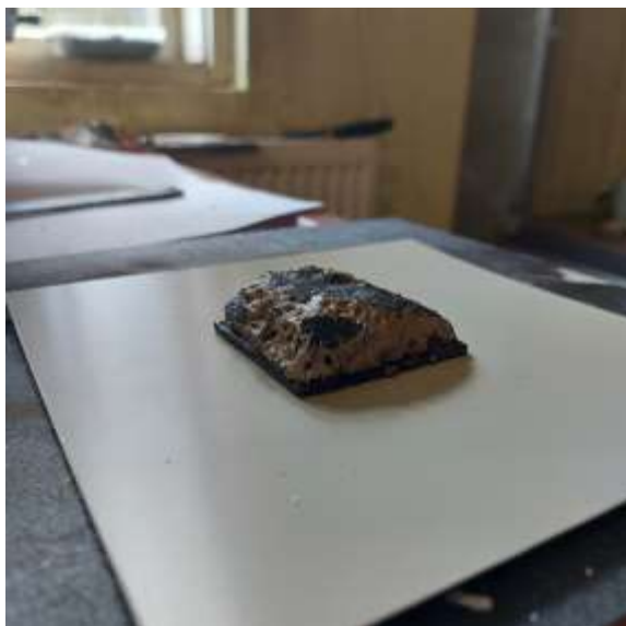
Рисунок 3.7 – Зразки сталевих пластин з покриттям після проведення випробувань
