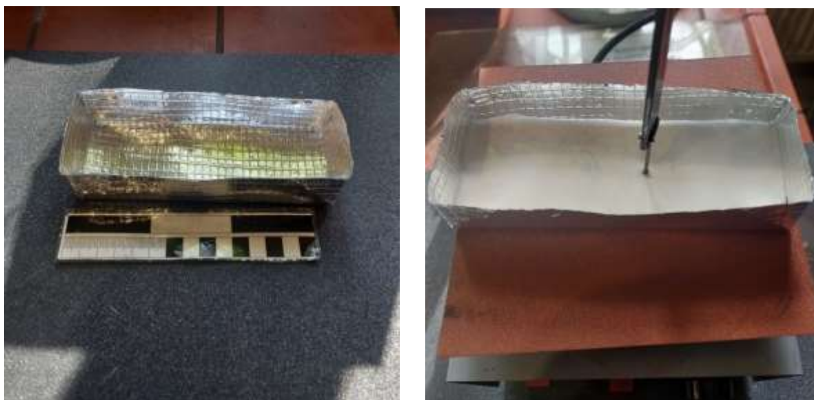
Рисунок 3.2 – Корзинка з алюмінієвої фольги із шаром покриття у сирому стані
