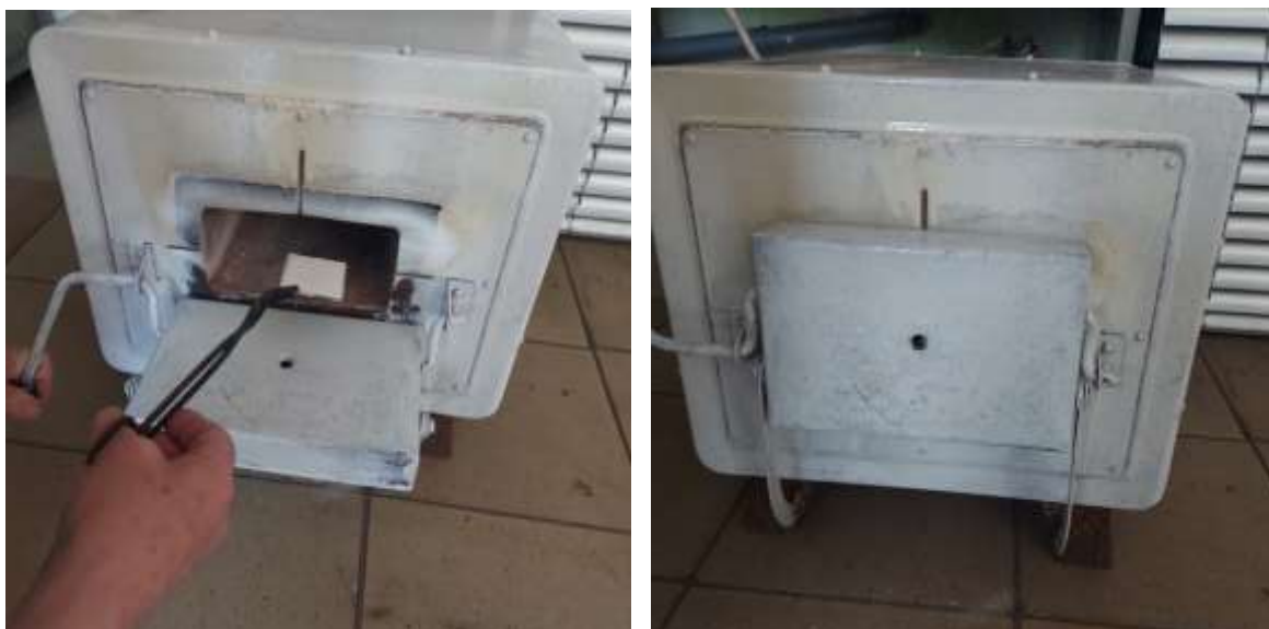
Рисунок 3.6 – Розміщення зразків сталевих пластин з покриттям у електропіч СНОЛ 2.5
