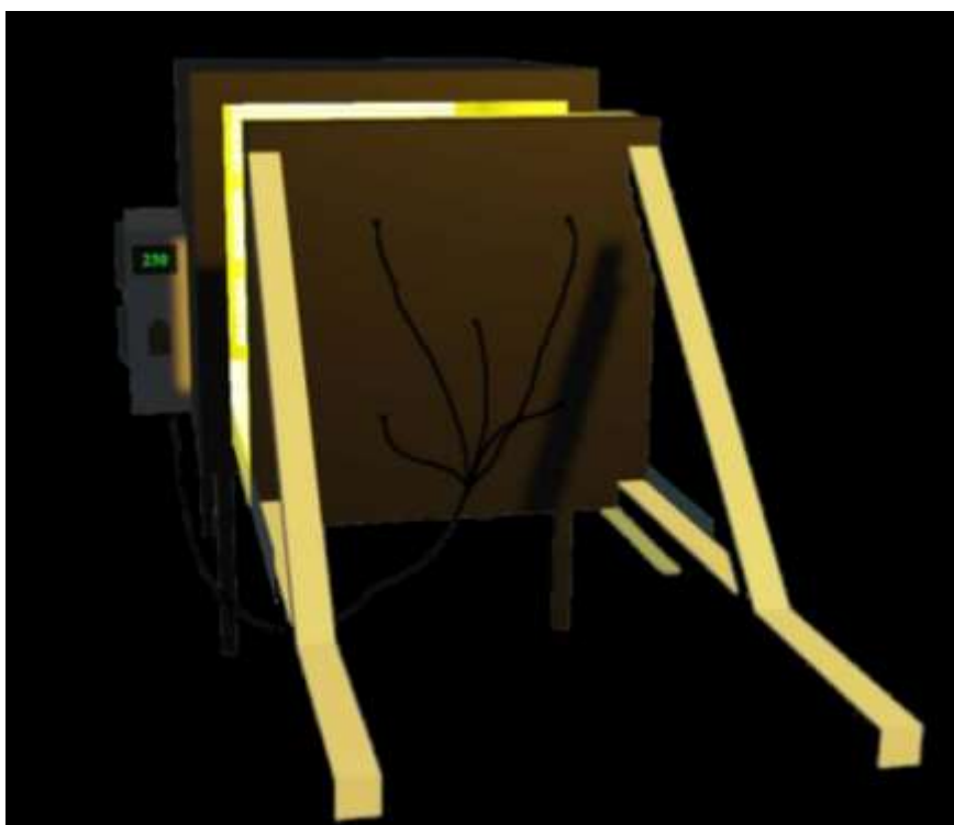
Рисунок 4.3 – Конструктивна схема встановлення зразків в установці для випробувань
