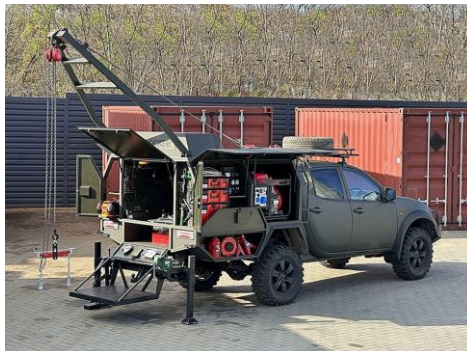
Рисунок 1 – Пересувна ремонтна майстерня на базі Mitsubishi L200
