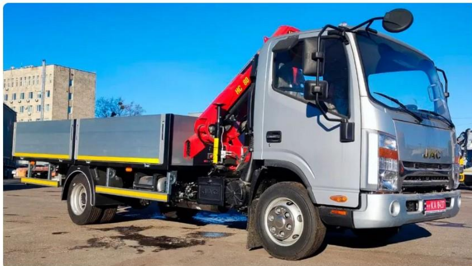
Рисунок 2 – Вантажний автомобіль JAC (JAC N75 + HC 80) із встановленим маніпулятором (гідрокраном).
