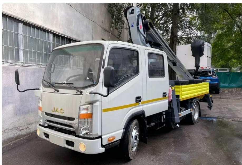
Рисунок 3 – Вантажний автомобіль JAC N56/N75 з автовежею.
