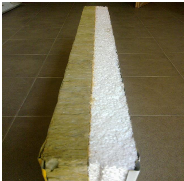
Рис. 5. Конструкція дослідного зразка
