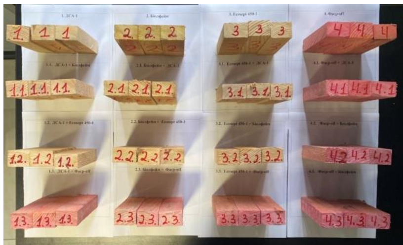
Рисунок 3.1 - 48 зразків, що були просочені вогнезахисними засобами ДСА-1, Біофлейм, Ecossept 450-1, Фаєр-off окремо кожним засобом та в подальшому в різних комбінаціях заміни вогнезахисного засобу.
