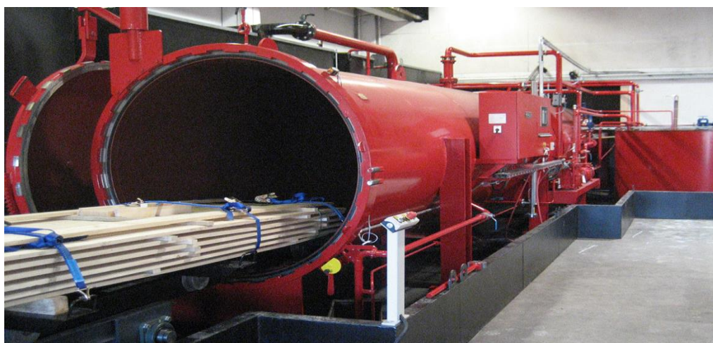
Рисунок 1.16 – технологія вогнезахисту дерев'яних будівельних конструкцій глибоким просочуванням.
