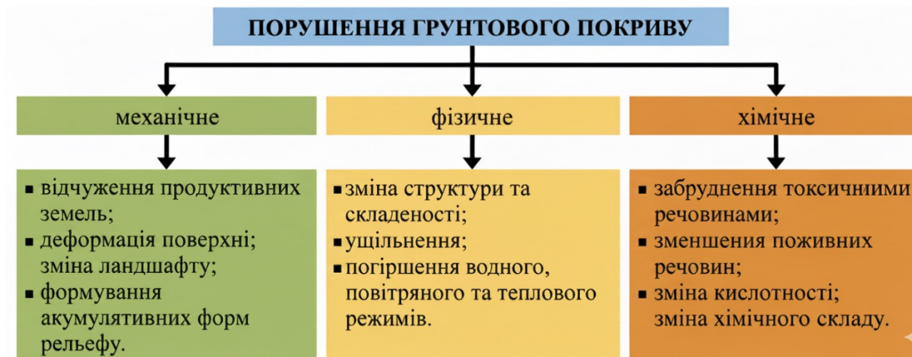
Рисунок 1.8 – Еколого-техногенний вплив сміттєзвалищ на ґрунтовий покрив [66]
