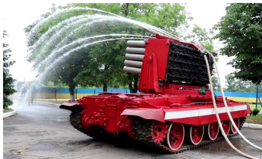
Рисунок 2 – Процес подачі вогнегасячої речовини
