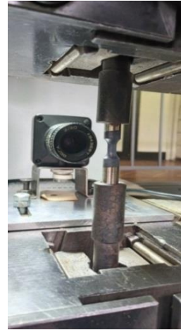
Рис. 3. Зразок у захоплювачах розривної машини. Fig. 3. Sample in the grippers of the breaking machine.
