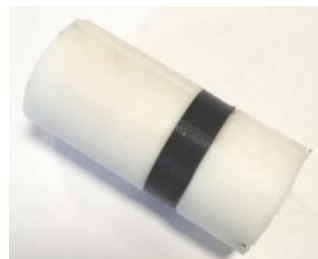
Рис. 13. Сопло зі встановленим на зовнішній поверхні жорстким кільцем
