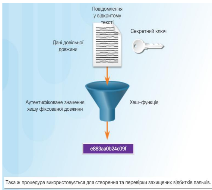
Рис. 6.10. Алгоритм хешування НМАС 79
